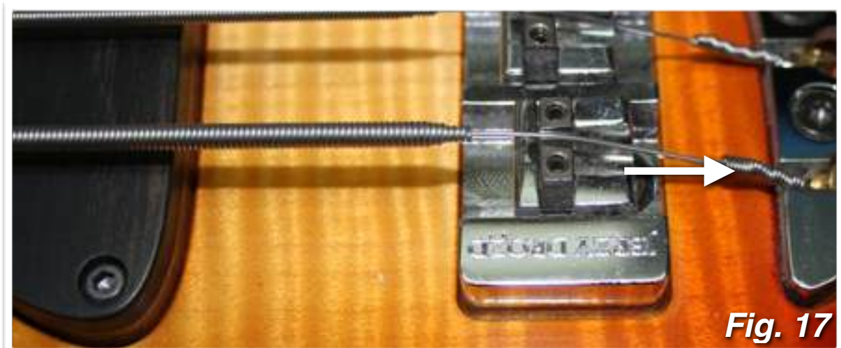
Cuanto mas alta es la nota del traste 12 respecto al armónico mas deberás desplazar el sillín hacia fuera para alargar la cuerda alejando el sillín de las pastillas Mueve el sillín alejando lo de la pastilla si la nota es mas alta que el armónico
