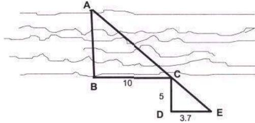
Para hacerlo, camina sobre la orilla 10 m. en dirección perpendicular a AB y clava una estaca (punto C). De C camina perpendicularmente 5 m hasta D y después paralelamente al río hasta estar en línea recta con AC (punto E). La distancia DE resulta ser de 3.7 m. ¿Cuánto mide el ancho AB del río?
