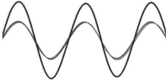
Figura 49. Excentricidad y espectro de vibración asociado [el Autor]
