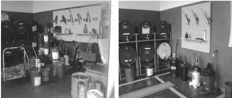
Figura 59. El antes y el después al aplicar Seiton a un Taller de lubricación [36]
