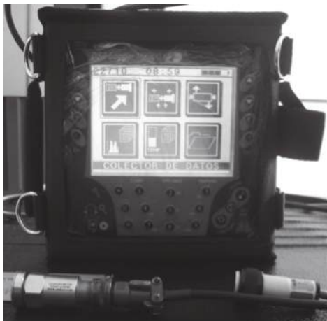
Figura 51. Equipo para medición y análisis de vibraciones UTP [el Autor]
