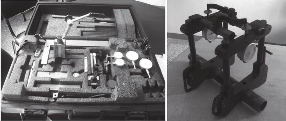
Figura 54. Equipo de alineamiento, método de los comparadores invertidos [el Autor]
