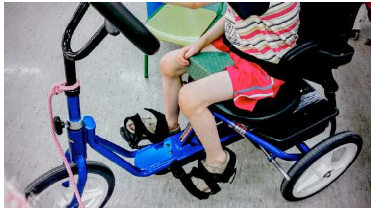
Un triciclo adaptado a partir de las posibilidades de movimiento del alumno y del análisis de las adaptaciones ortopédicas que pudieran mejorar su autonomía en el mismo. Fotografía de Carmen María Vera Leante
