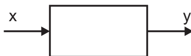
Figura 1.22: Sistema sobre el que actúa una variable de entrada x obteniéndose como respuesta una variable de salida y .
