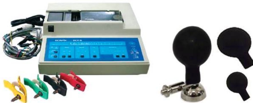
Figura 4: Eletrodos de derivação bipolar, aparelho de ECG com eletrodos e eletrodo precordial, respectivamente.
