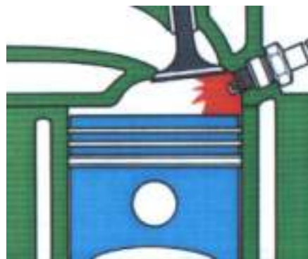
Figura 172 - Propagação da centelha
