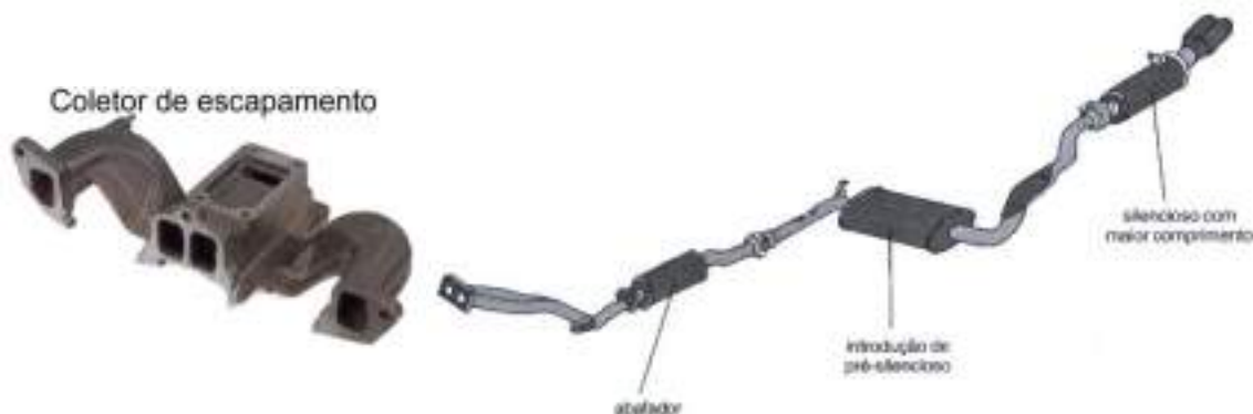
Figuras 137 e 138 - Componentes do sistema de escapamento
