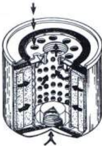
Figura 87 – Funcionamento do filtro de óleo
