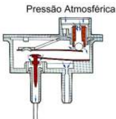
Figura 117 - Válvula sem vácuo
