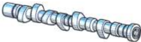
Figura 27– Comando de válvulas
