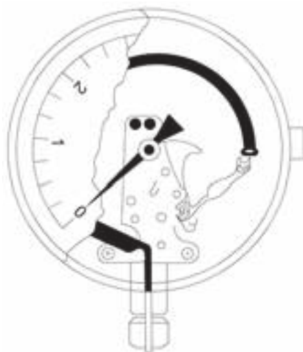
Figura 11 – Manômetro de Bourdon (em corte)
