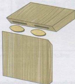
Ensamble en corte de inglete reforzado por láminas
