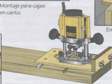
Montaje para preparar ranuras paralelas.
