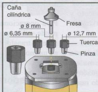
Diferentes diámetros de cañas de fresas y pinzas.
