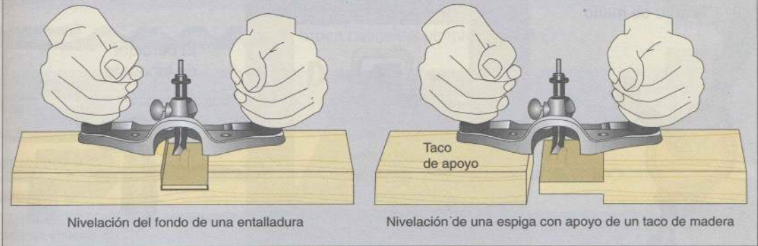
Figura 34. Utilización de la guimbarda de fondo
