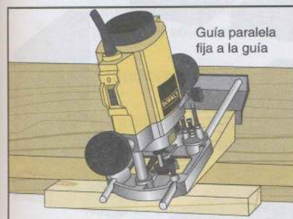
Montaje para preparar un bisel o una moldura plana con una fresa plana para superficies.
