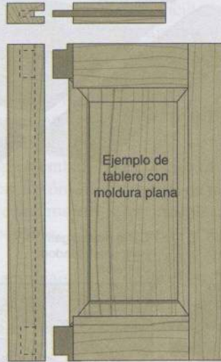
Bastidor con ranura y tablero embarbillado
