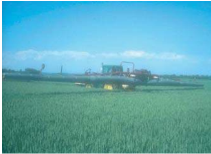
Lámina 64 Pulverizador de barra montado en tractor con funda de aire para reducir la deriva de herbicidas (T. Friedrich)
