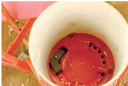
Lámina 100 Detalle del interior de una tolva de semillas de una plantadora de precisión con plato de semillas para distribuir las semillas. (V.H. de Freitas)
