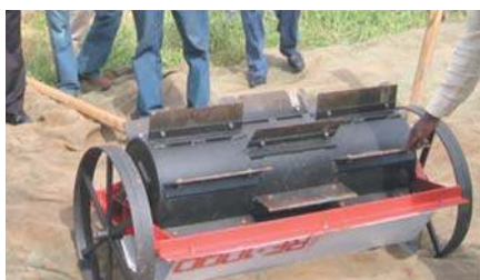
Lámina 42 Rodillo de cuchillas de tracción animal en posición de transporte (T. Friedrich)
