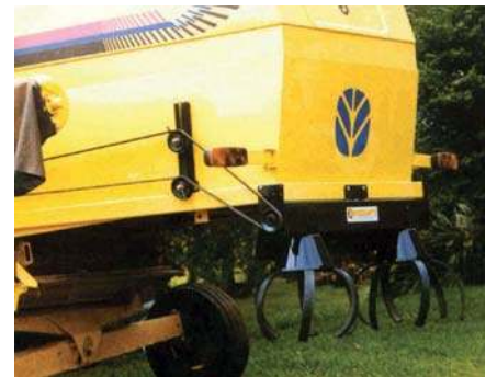
Lámina 56 Diseminador de paja en combinada (MAX - Irmãos Thonnigs Ltda.)
