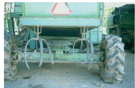
Lámina 57 Diseminador de paja construido por agricultor (T. Friedrich)
