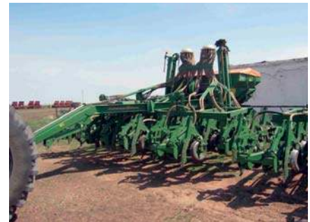
Lámina 97 Sembradora a chorrillo neumática de no labranza, con dos unidades centrales de medición y distribución (T. Friedrich)
