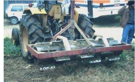
Lámina 48 Rodillo de cuchilla montado en tractor (T. Friedrich)
