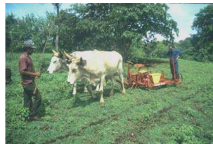
Lámina 75 Plantadora perforadora de inyección rodante de dos hileras. Friedrich)
