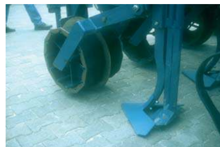
Lámina 90 Abridor de surco tipo azada de alas anchas. (T. Friedrich)
