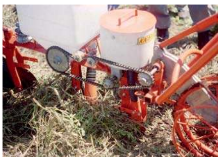
Lámina 78 Tanto el plato de semillas como la ranura dosificadora de fertilizante son activados por el movimiento de las ruedas. En este caso una cadena conecta las partes en movimiento. (A.J. Bot)
