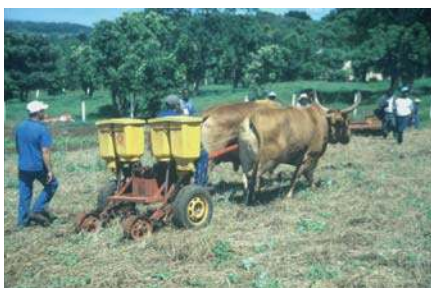
Lámina 82 Una sembradora de carretilla de dos hileras para tracción animal. (T. Friedrich)
