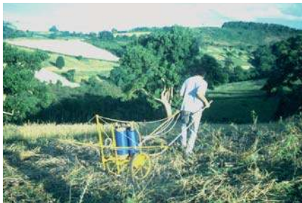
Lámina 59 Una mochila pulverizadora adaptada para tracción manual. (T. Friedrich)
