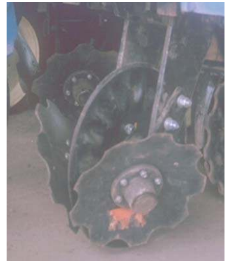
Lámina 83 Limpiador de hileras combinado con disco de corte. (T. Friedrich)
