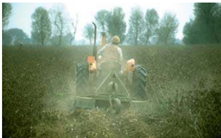
Lámina 53 Chapeadora de tractor usada para cortar residuos de algodón. (T. Friedrich)
