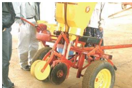
Lámina 72 Sembradora con abridor de doble discos y ruedas de presión de hierro fundido (T. Friedrich)
