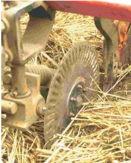
Lámina 84 Disco de corte. (T. Friedrich)
