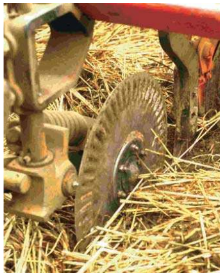
Lámina 70 Disco de corte (T. Friedrich)
