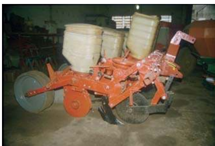
Lámina 101 Modificando una plantadora de precisión convencional para su uso en no labranza: adicionando un disco de corte en el frente y remplazando los abridores de surco para fertilizante y semillas. (T. Friedrich)
