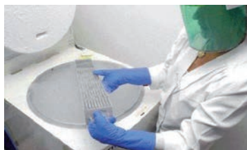
Fig. 2.45 Criogenización con nitrógeno líquido.
