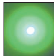
Fig. 2.22 Anillos de difracción de los electrones.
