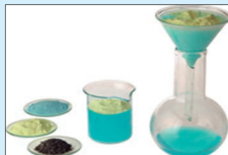
Fig. 1.25 Filtración de una mezcla heterogénea de azufre, hierro y sulfato de cobre.
