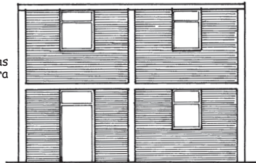
Vanos de ventanas y puertas bien ubicados
