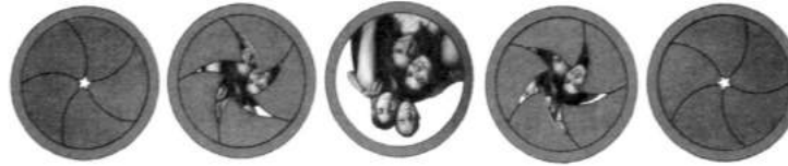
Esquema de funcionamiento del Obturador Central
