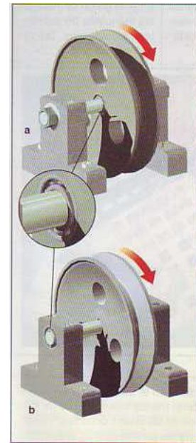
Fig. 2. Tipos de ejes: a) fijo; b) giratorio.
