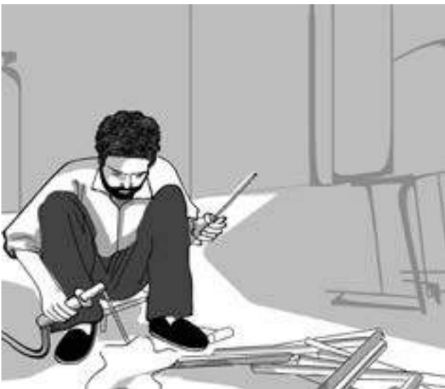
3 - Ne pas procurer de masque de soudage revient à exposer les yeux, le visage et le cou du travailleur à des brûlures par éclats, à la chaleur, aux rayonnements ultraviolets et infrarouges. Une protection adéquate des mains, comme des gants, doit être fournie, car les blessures aux mains sont très communes.
