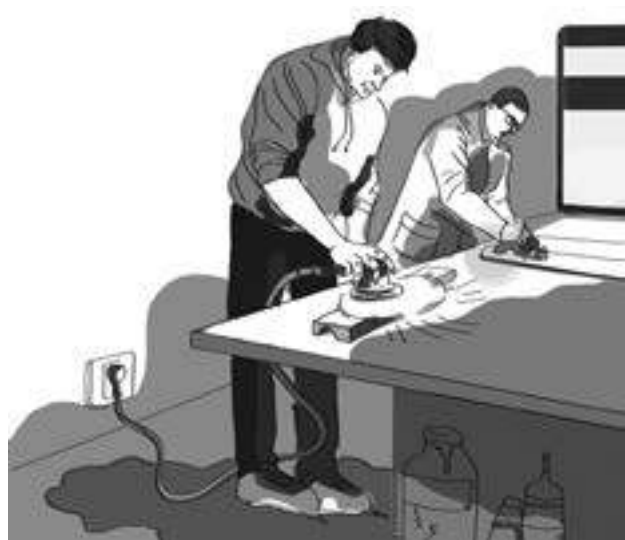
4 - Les fils électriques sur un sol mouillé peuvent conduire à des court-circuits et au feu sur le lieu de travail, pouvant être la cause d'accidents mortels.
