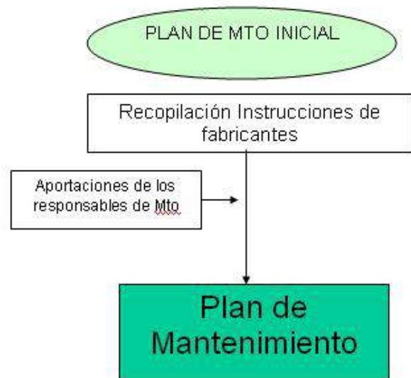
Fig. 1 Diagrama de flujo para la elaboración de un plan de mantenimiento basado en las recomendaciones de los fabricantes
