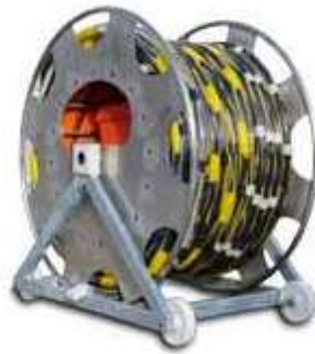
Figura 4.12 Streamer de 120 m, composta por hidrofones espaçados de 3.125 m com 24 canais. Fonte: (Geo Marine, s.d.).
