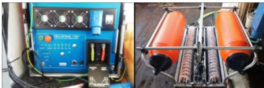
Figura 4.11 Do lado direito temos o Geo-Source ligeiro de 200 pontas e do lado esquerdo a fonte de alimentação pulsada Geo-Sparker de 1 KJ.
