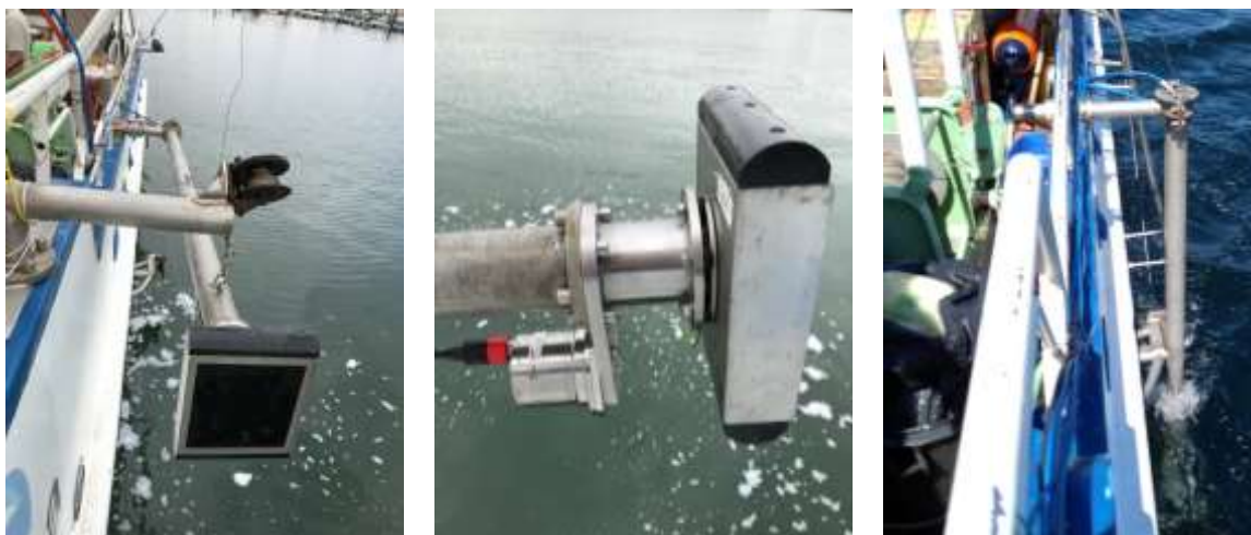
Figura 4.16- Sonda paramétrica (PE) instalada a bordo no NI Diplodus. A esquerda tem-se o poste lateral montado com a PE, ao centro pode-se ver a instalação do IMU e à direita o poste com os equipamentos mergulhados, posição de aquisição.
