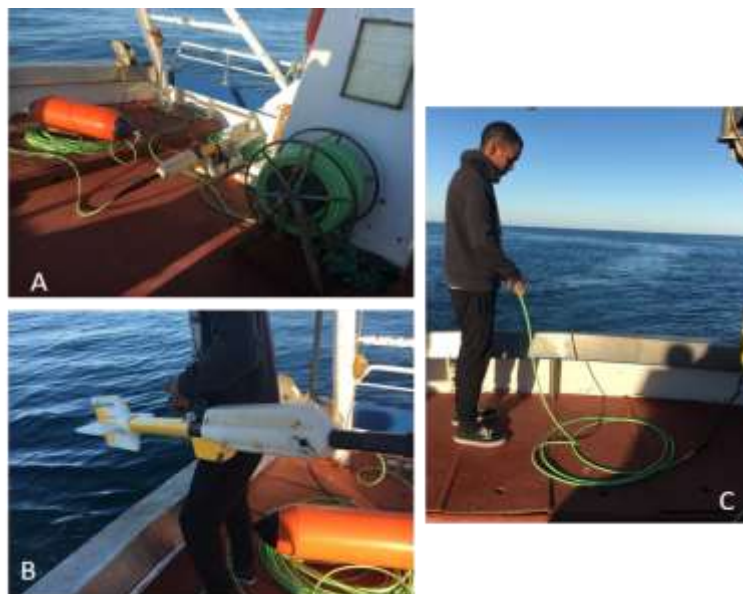
Figura 4.8 O “A” demonstra o acondicionamento do sistema de aquisição de dados magnéticos a bordo do navio Diplodus, “B” e “C” Operação de lançamento do magnetômetro na água.
