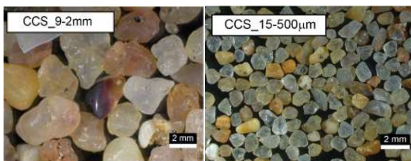
Figura 7.1 Exemplo de Imagens de amostras superficiais com teores de cascalho entre 12-18% (esquerda), e imagem de classe de areia grosseira dominante (direita). Fonte: (Mil-Homens, et al., 2019a).
