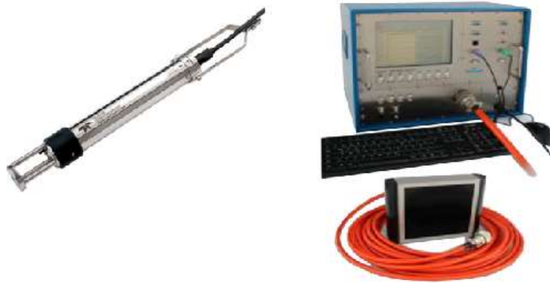
Figura 4.14 Do lado esquerdo temos o SVP e do outro lado o Sistema de sonda Innomar SES-2000 Standard. Direita: (Innomar, 1997); Esquerda: (Seatronics, 1978).
