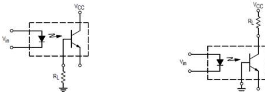
Figura 4.79: Circuitos básicos con optoacoplador con fototransistor
