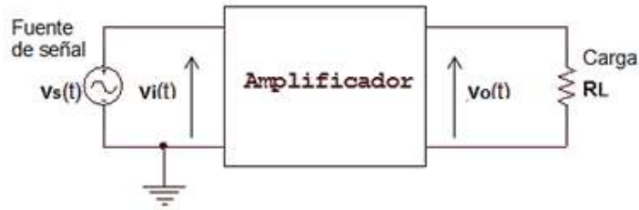
Figura 2.46: Esquema básico de un amplificador
