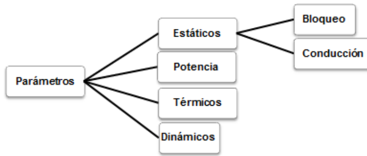
Figura 1.66: parámetros típicos en hoja de datos de diodos
