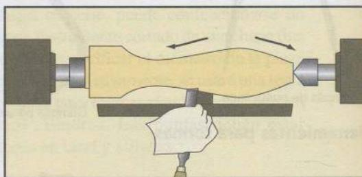
⑥ Realice el perfil que desee con la gubia para perfilar; y luego termine la labor con la plana para lograr un buen acabado.
