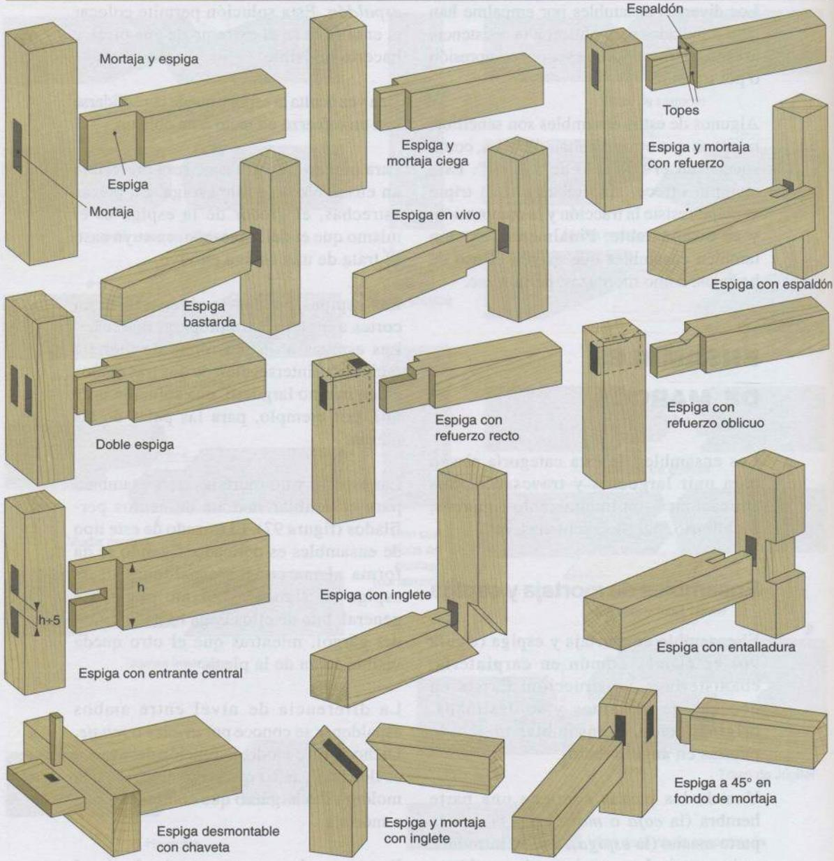
**Figura 96. Ensamblajes de mortaja y espiga**
