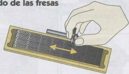
Una piedra diamantada de grano fino lubricada con agua permite afilar todas las clases de fresas (HSS o al carburo).
