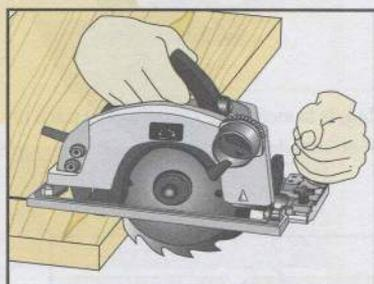
① Fije sólidamente la pieza: Coloque la sierra delante de la línea de corte y ajuste la base a la tabla. Encienda la máquina y espere a que el motor alcance el régimen de funcionamiento antes de empujar la sierra.
