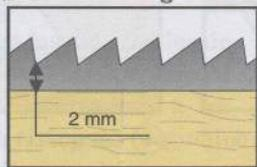
3 La lima triangular debe colocarse perpendicularmente a la hoja (salvo para afilados en bisel). Ha de casar perfectamente con la parte baja del dentado. Lime sólo empujando. Bastarán una o dos pasadas por diente.
