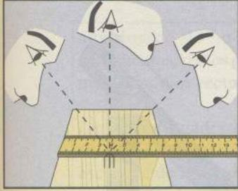
Para evitar los errores de paralaje, coloque el metro perpendicularmente a la tabla
