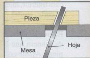
Tronzado oblicuo con inclinación de la hoja (máquina vista en corte).
