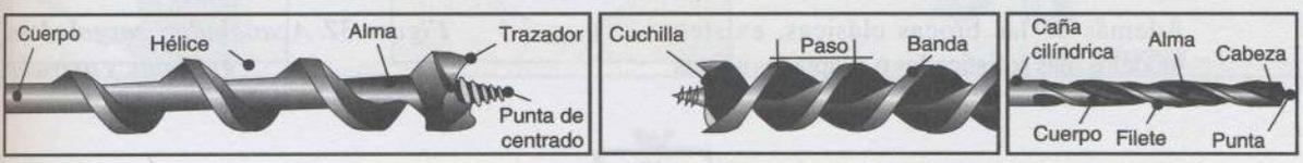
permite, entonces, accionar el portabrocas sin necesidad de dar una vuelta completa al cuadro. La velocidad de giro del portabrocas depende de la fuerza desplegada por el brazo. El berbiquí puede usar brocas específicas de gran tamaño y grueso diámetro, como las americanas y las helicoidales o espirales (figura 36).
