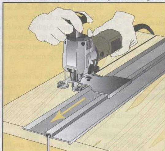
Para cortar un disco, use una guía y una punta de centrado.
