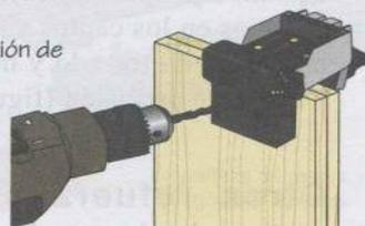
Figura 93. Guía de ensambles con clavijas
