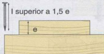
Utilice puntas de longitud suficiente (de 2 a 2,5 veces el grosor de la pieza).
