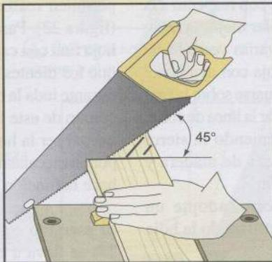
⑥ Una vez asegurado el corte, oriente la hoja en un ángulo de  $45^\circ$  y sierra con toda su longitud.
