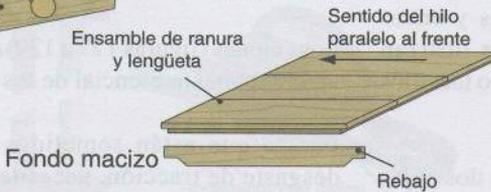
El fondo se desliza por ranuras acopladas al frente y los costados, y pasa debajo del travesaño de la trasera. Después se atornilla o se clava a esta trasera, pero nunca se encola.
