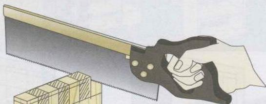
① Coloque la pieza en una prensa y sierre las colas.
