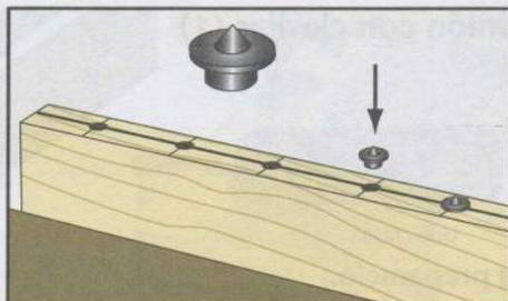
① Taladre las posiciones de las clavijas perfectamente en perpendicular, con algo más de la mitad de su longitud. Para ajustar bien, puede usar un tope de profundidad en la broca.
