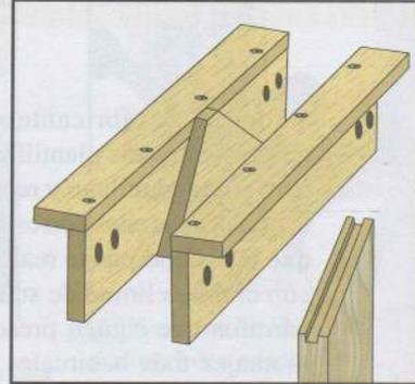
Montaje para ranurar en madera a contrahilo con corte en inglete.
