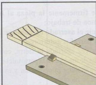
① Señale el trazo de corte, marque la parte que se va a cortar y fije sólidamente la pieza de corte.
