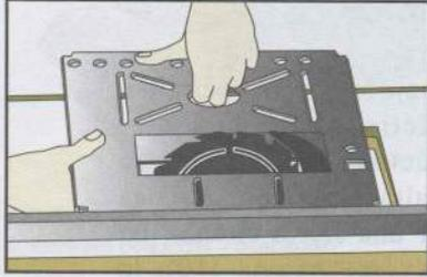
Desmontaje y montaje rápidos de la pletina para cambiar de herramienta.
