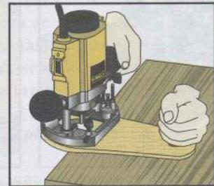
El uso de una falsa mesa sostenida con el puño evita el basculamiento de la fresadora mientras se trabaja con los cantos.
