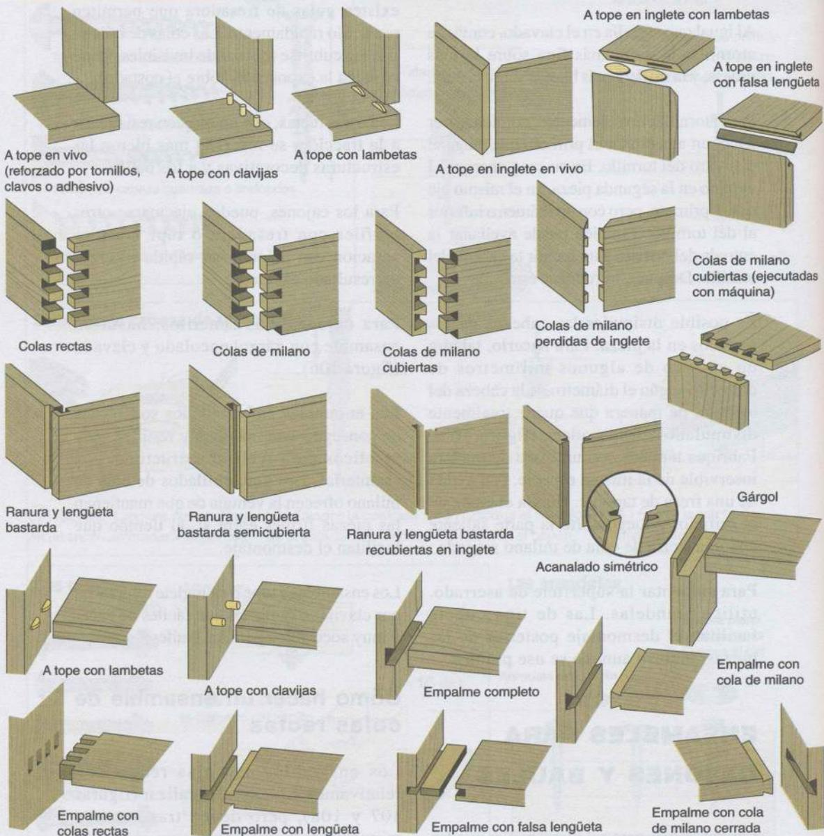
Figura 106. Ensamblajes de cajones y baúles
