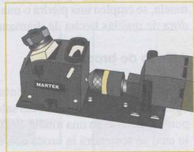
Una afiladora de brocas facilita esta operación. En la imagen, afiladora activada por una taladradora.
