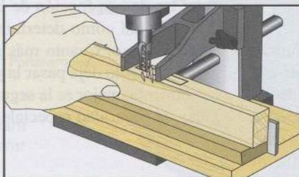
Figura 79. Preparación de una mortaja con formón hueco
