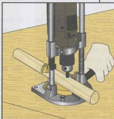
Uso de la guía para taladrar una pieza cilíndrica.
