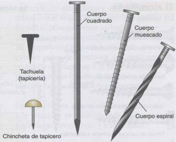
Las puntas, que ofrecen una buena resistencia al arranque, se utilizan en cajas, baúles y construcción.
