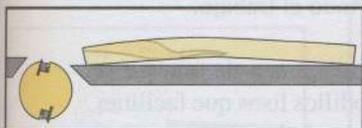
① Coloque la pieza con la cara cóncava apoyada en la mesa.
