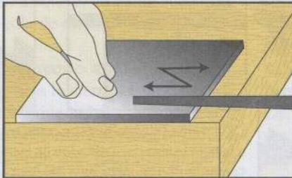
② Coloque la rasqueta en el banco a un centímetro del borde. Pase el bruñidor con un movimiento de vaivén en todo el borde.
