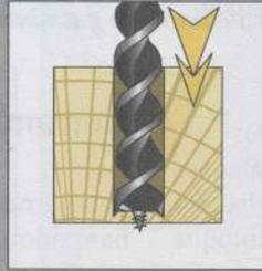
Después, abordar el taladro por el otro extremo del orificio guiándolo con la punta de la broca.
