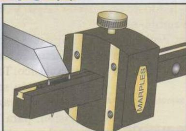
② Ajuste el gramil de ensamblaje al grosor del escoplo.
