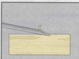
Formón usado con el bisel hacia arriba para penetrar poco en la madera.
