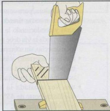
⑦ Hacia el final del corte, enderece la hoja y sierra suavemente para evitar astillas. Sujete la parte inservible con la otra mano.
