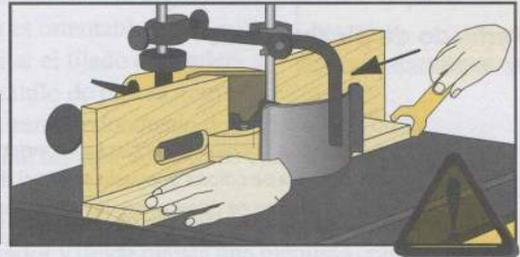
④ Cuando la longitud de una pieza sobrepasa los protectores, vuelva a colocar la mano izquierda y empuje la pieza con un elemento auxiliar.
