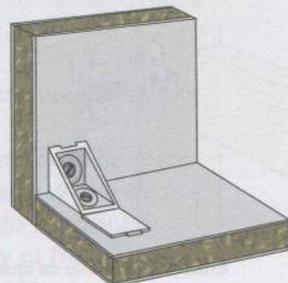
Figura 113. Ensamblados de tableros de partículas
