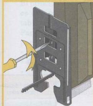
① Desatornille la base de la máquina.
