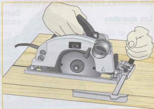
Cortar una pieza con una guía paralela.
