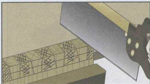
① Sierre la pieza de forma que los lados derechos de las colas queden en vertical, y luego siérrelos con una sierra de espiga. Proceda de igual manera en los lados izquierdos.
