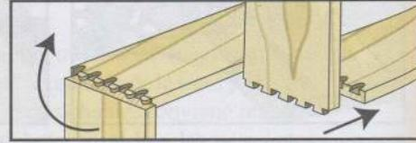
④ Sólo queda girar una de las piezas y proceder al montaje y ensamblado.
