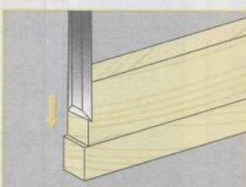
Coloque una protección bajo la pieza.
