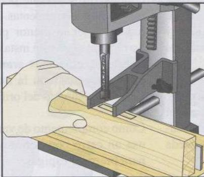
2 Marque la caja en la pieza. Su grosor debe corresponder al del formón de que dispone. Coloque la pieza y encienda la máquina.
