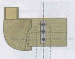
② Trace el eje de la puerta en posición abierta (90° o 100°), sitúa en la intersección con una holgura de 5 mm.
