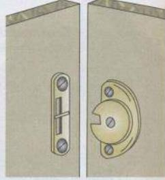
Diversos herrajes de ensamblado desmontables
