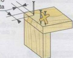
Utilice puntas de un diámetro adecuado y no las hunda en exceso en los bordes de la pieza.
