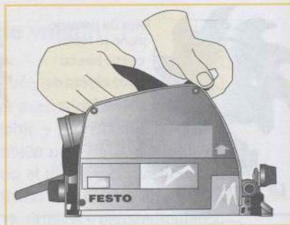
② Introduzca la hoja en la pieza y comience a serrar. Un tope de profundidad permite realizar cortes precisos. Este modelo de sierra permite realizar cortes en medio de una pieza.
