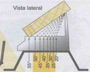
El soporte ranurado de la sierra de marquetería permite realizar cortes de ángulos en entrada o en salida.
