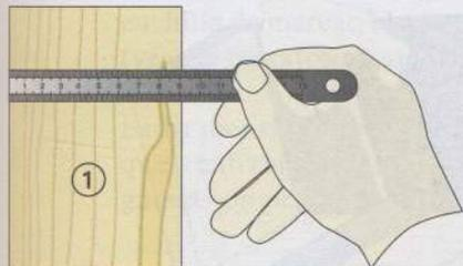
Para dividir una tabla, por ejemplo en cinco partes, coloque una regla sobre una de sus aristas.
