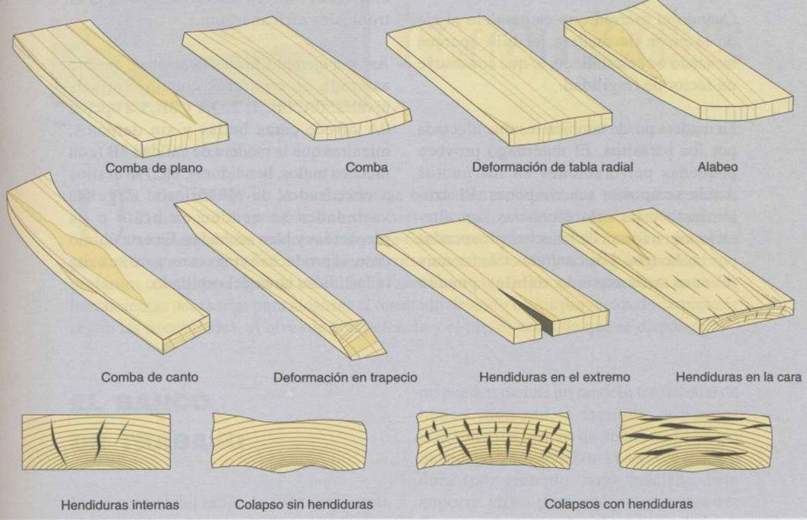
Figura 7. Defectos y alteraciones de la madera
