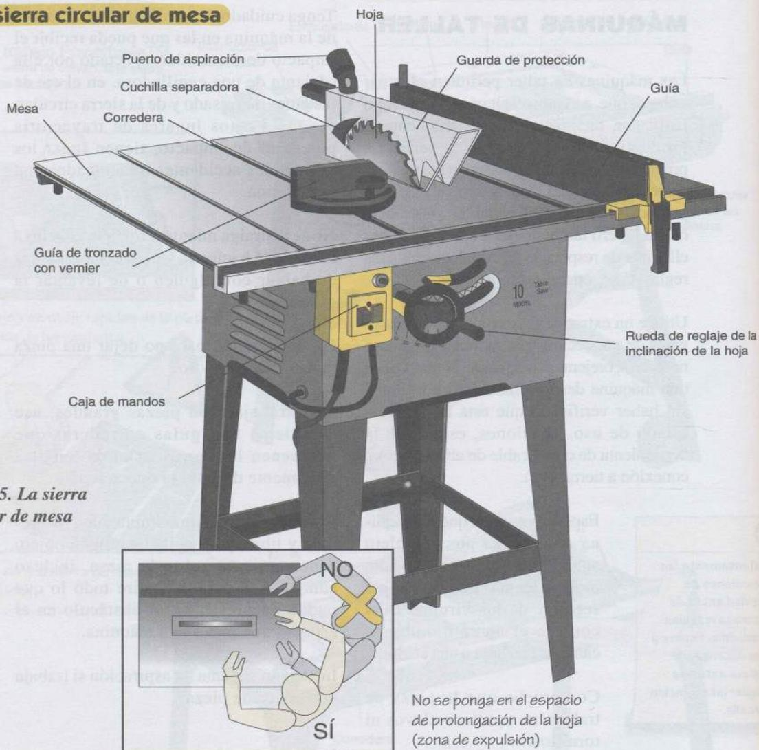
Esta máquina es, por desgracia, una de las más peligrosas (junto con la fresadora), lo que obliga a respetar escrupulosamente las instrucciones de seguridad del fabricante y los métodos de trabajo propuestos.
