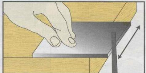
④ Coloque la rasqueta en el banco sobrepasándolo un centímetro. Pase el bruñidor por la arista con un movimiento de traslación apoyándose cada vez con más fuerza en cada pasada e inclinando el bruñidor  $5^\circ$  como máximo.
