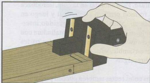
① Trace la línea de enrase correspondiente a una vez el grosor de la pieza. Efectúe un segundo trazado por la mitad.
