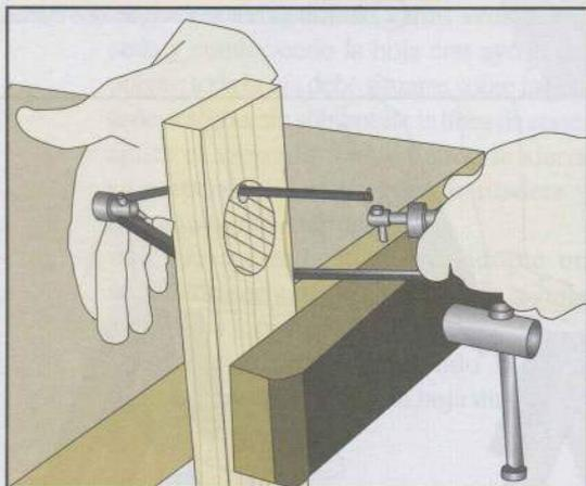
Haga un agujero por la parte que no sirva, desmonte la hoja de la sierra e introdúzcala en ese agujero. Vuelva a montar la hoja en la montura y luego proceda al aserrado según la línea marcada.
