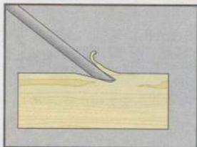
Formón usado con el bisel hacia abajo para penetrar profundamente en la madera.
