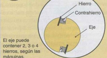
El eje puede contener 2, 3 o 4 hierros, según las máquinas.
