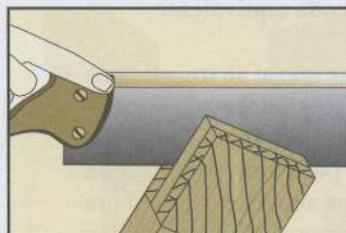
⑦ Fije sólidamente el travesaño inclinado a unos  $30^\circ$ . Sierre hasta el principio del enrase.
