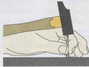
Embote el extremo de la punta para no abrir una pieza fina.
