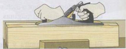
1 Las piezas deben tener los cantos correctamente cepillados. Los extremos de la pieza deben rozar uno con el otro si se imprime un movimiento de rotación.
