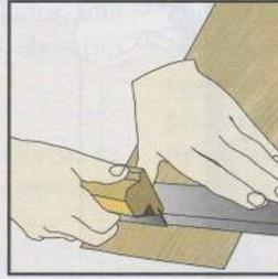
② Corte las láminas longitudinalmente con un sobrante.
