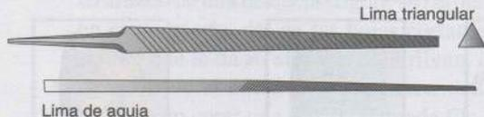
2 Se utiliza una lima triangular o una lima de aguja, adaptadas al tamaño y a la forma de los dientes de la sierra que se va a afilar.
