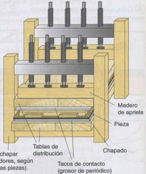
Bastidor de enchapar (de 4 a 8 bastidores, según la longitud de las piezas).
