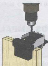
3 Taladre la posición de la clavija de la cara. Desplace la guía y proceda con los taladros de las otras posiciones.
