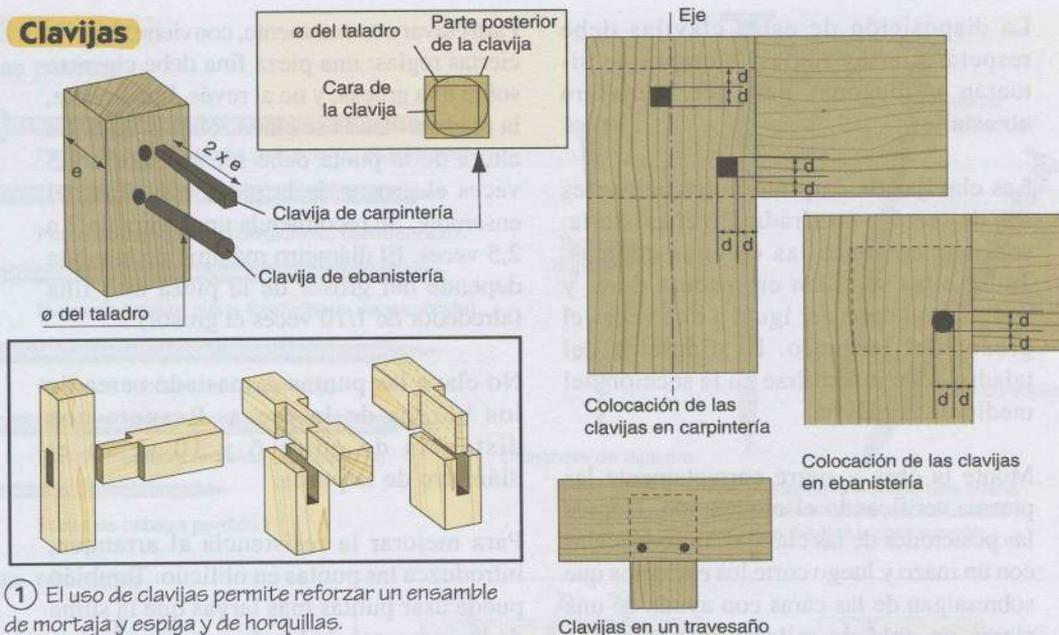
① El uso de clavijas permite reforzar un ensamble de mortaja y espiga y de horquillas.
