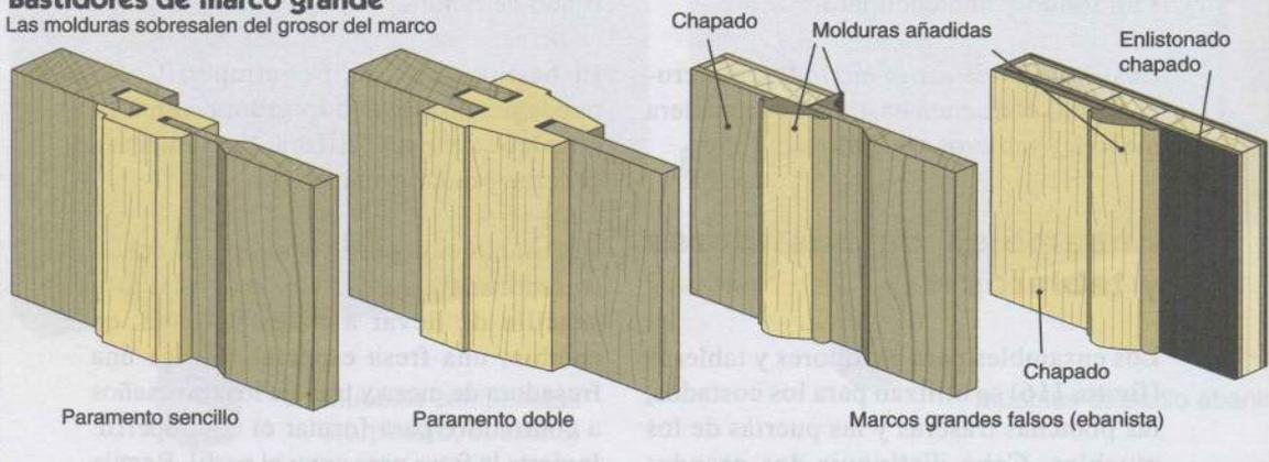
Figura 116. Ensamblajes de bastidores y tableros
