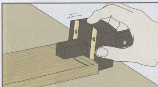
② Marque las colas con el gramil (anchura del lado menos grosor del recubrimiento, con una holgura de 3 mm).
