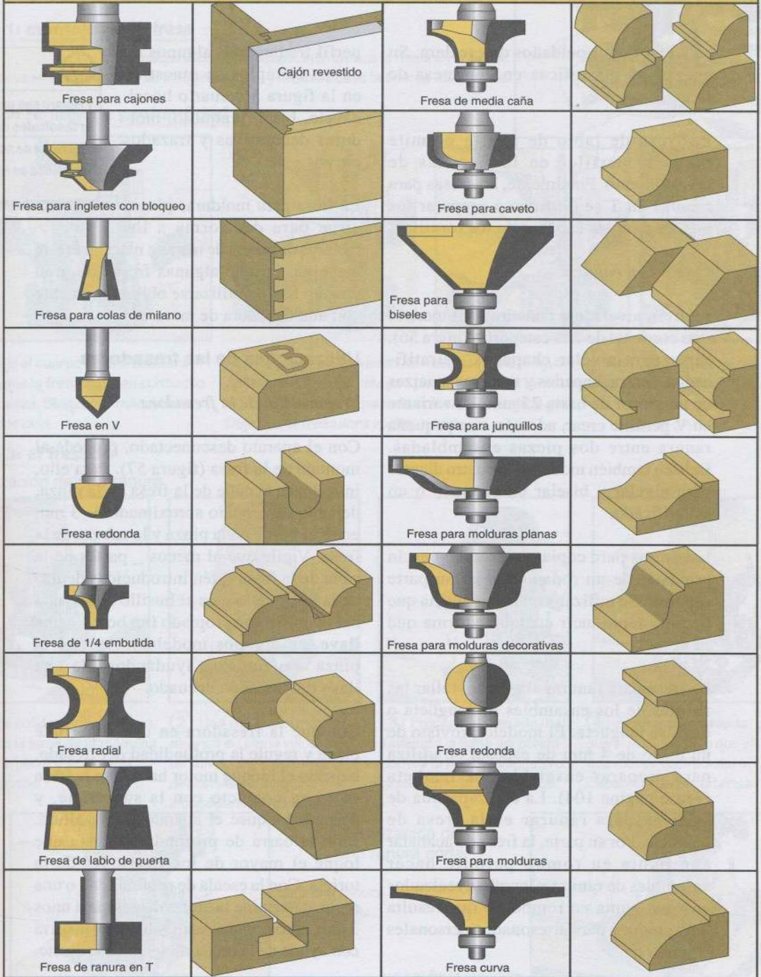
Figura 56. Fresas de la fresadora (2)
