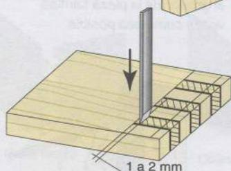
③ Coloque verticalmente un formón cuya anchura se adapte hasta algunos milímetros al fondo de la entalladura.
