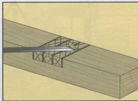
② Prepare la entalladura con un formón para madera, levantando la madera entre cada dos marcas de sierra.
