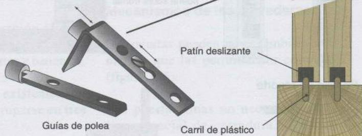
Figura 125. Mecanismos deslizantes
