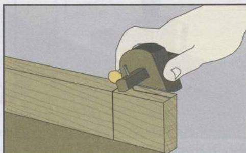
② Trace los lados del ensamblaje con el gramil (mitad de espesor).
