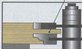
① Utilice una fresa de perfil contraperfil. Trabaje en los extremos de los travesaños (con la cara de referencia o vista hacia arriba). Coloque la pieza en un carro para preparar espigas.
