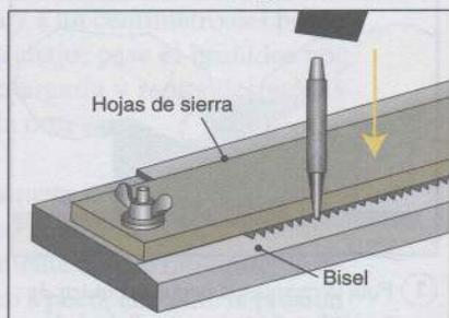
Para hojas de dentado pequeño, el triscado se lleva a cabo con un punzón sobre una pieza metálica biselada.
