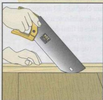
① Inicie el corte con el lomo dentado. Puede guiar la hoja de la sierra con un taco de madera o una regla.
