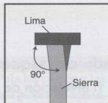
3 Puede fabricarse una guía para pasar la lima en dirección perfectamente perpendicular sobre la hoja.
