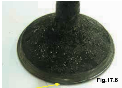
Desgaste na região do assento da válvula
