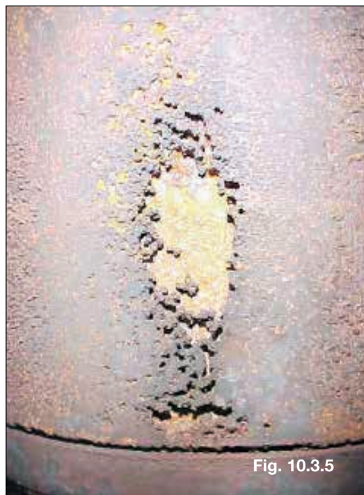
Cavitação sem corrosão
