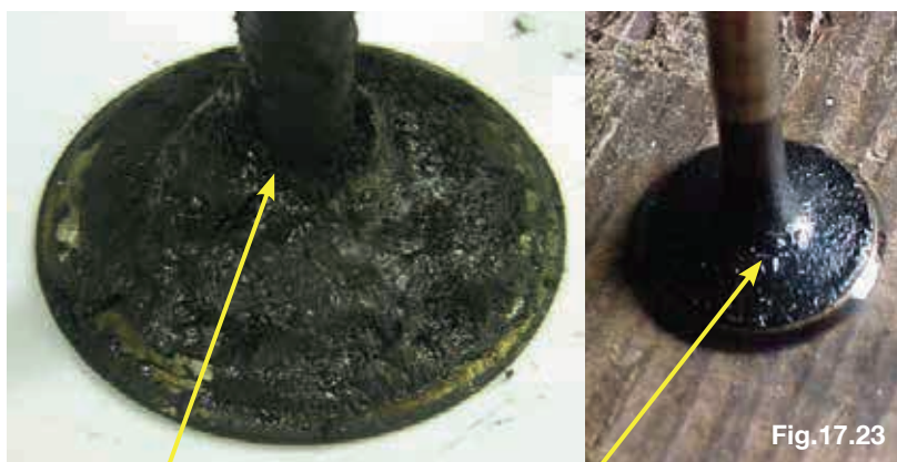
Válvula de admissão com contaminação de crosta de óleo lubrificante devido à folga excessiva entre guia e haste e/ou à deficiência do retentor/vedador
