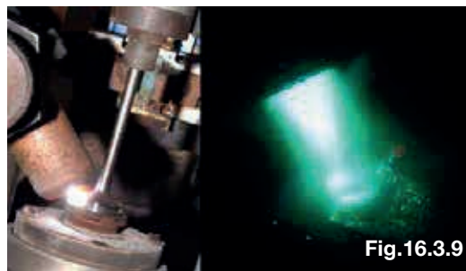
Blindagem da sede da válvula
