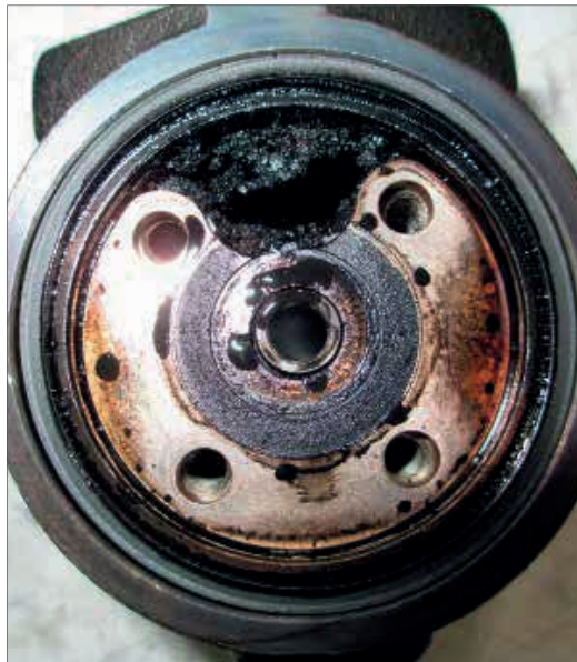
Fig. 22.3.3 – Carbonização do óleo lubrificante decorrente da temperatura elevada.
