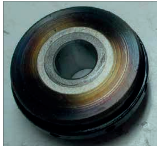
Fig. 22.1.1.4 – Lubrificação deficiente no colar centrífugo.
