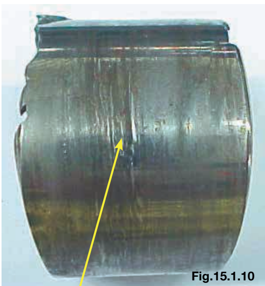
Marca do embuchamento incorreto
