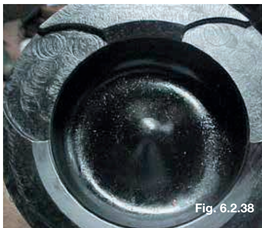
Marcas de usinagem do topo do pistão e rebaixo de válvulas
