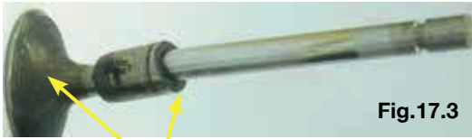
Empenamento devido ao atropelamento da válvula pelo pistão
