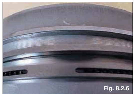
Anel da terceira canaleta desgastado
