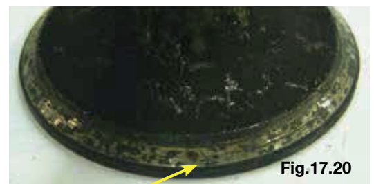
Pontos de contaminação do assento da válvula por resíduo de carbono
