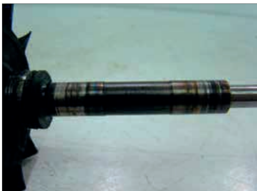
Fig. 22.1.1.2 – Lubrificação deficiente no eixo rotor.
