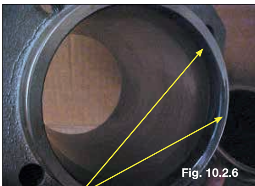
Apoio irregular entre a parte superior da camisa e o cabeçote
