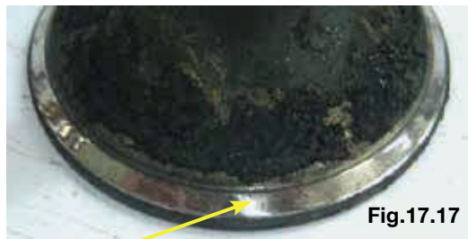
Desgaste na região da cabeça da válvula
