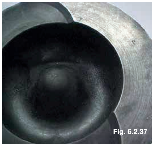
Marcas de usinagem do topo do pistão
