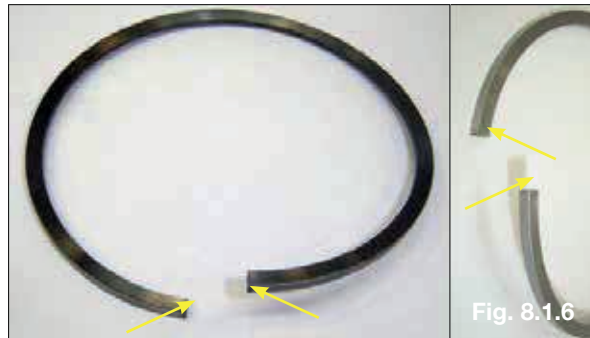
Pontas desalinhadas devido à montagem incorreta
