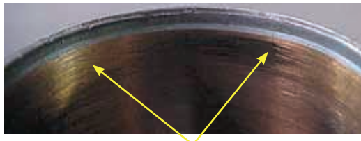
Riscos normais e espessura correta da parede
