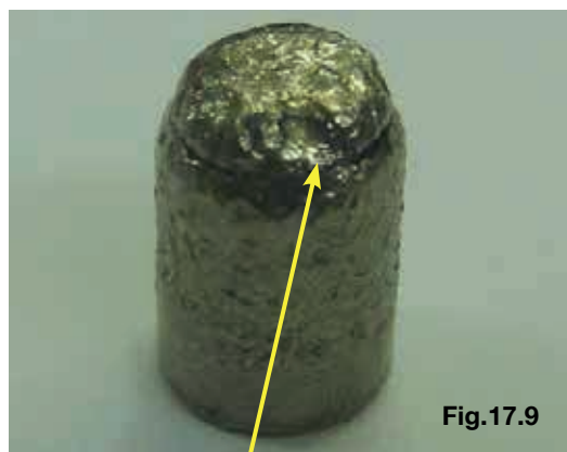
Quebra na região do canal de trava
