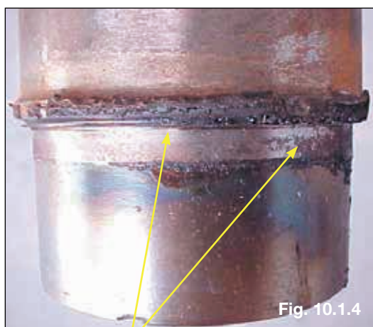
Cola na região de apoio da camisa no bloco
