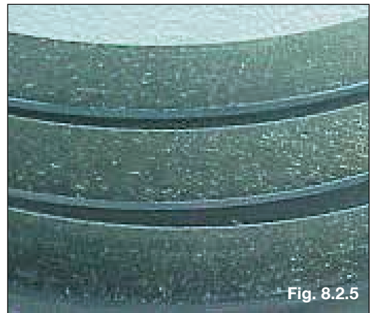
Anel com partículas abrasivas na lateral
