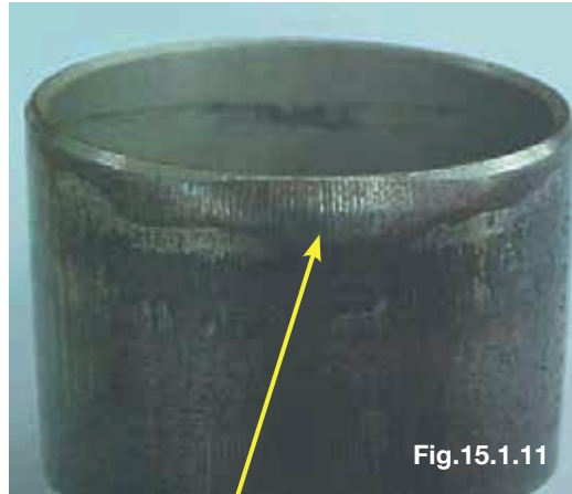
Marca do embuchamento inclinado
