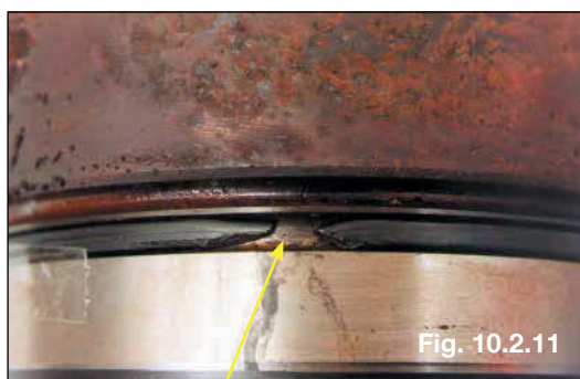
Fig. 10.2.11 Anel o'ring cortado durante a instalação da camisa no bloco
