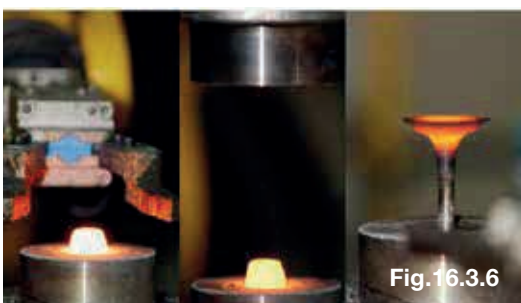
Definição da forma geral da válvula
