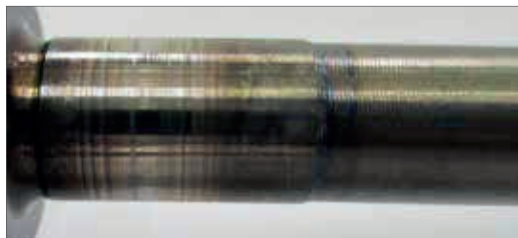
Fig. 22.1.2.2 – Riscos provocados por óleo lubrificante contaminado.
