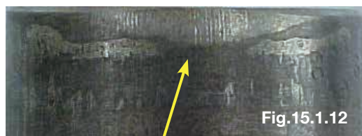
Marca do embuchamento inclinado
