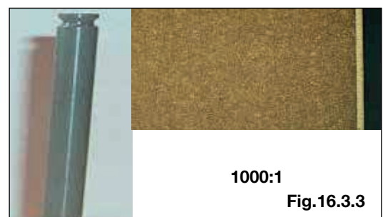
Ampliação da camada de cromo aplicado na haste
