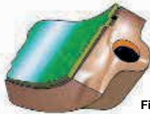
RESSALTOS DE CENTRAGEM NÃO COINCIDENTES
