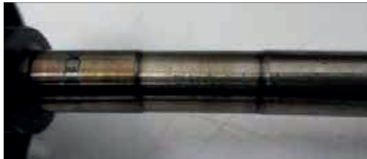
Fig. 22.1.1.6 – Marcas circulares no eixo, indicio de parada a quente.
