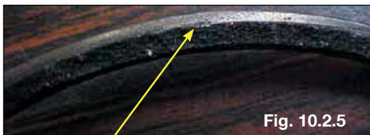
Região do colarinho da camisa carbonizado
