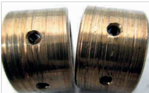
Fig. 22.1.2.1 – Riscos provocados por óleo lubrificante contaminado.
