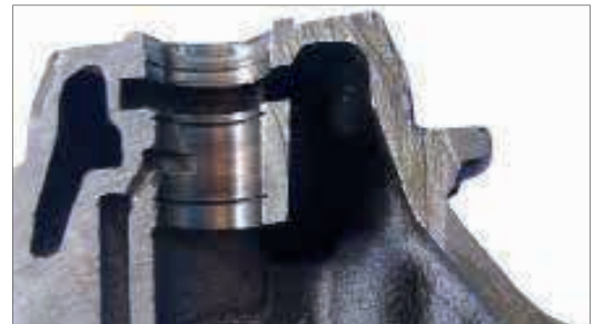
Fig. 22.1.1.3 – Riscos no alojamento da carcaça central.
