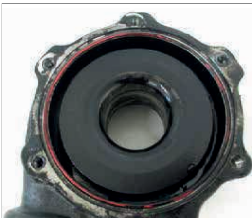
Fig. 22.5.3 – Óleo lubrificante na carcaça compressora, provocado por restrição de ar.
