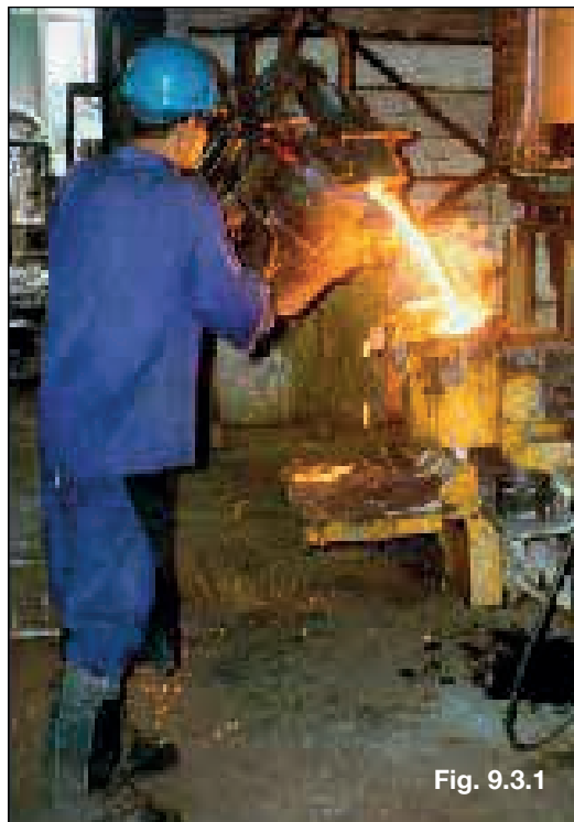
Fund. centrífuga: alimentação da máquina, retirada do tubo e alívio de tensão.
