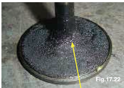
Válvula de admissão contaminada com óleo lubrificante devido à folga excessiva entre a haste e a guia ou a retentor/vedador deficiente
