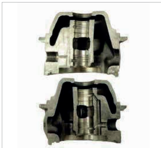
Fig. 22.1.2.3 – Carcaça central com riscos causados por impurezas.
