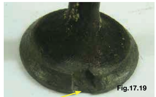
Desintegração localizada na região do assento da válvula
