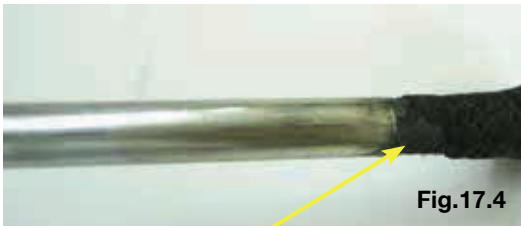
Engripamento em função de resíduos de carvão fixados na haste
