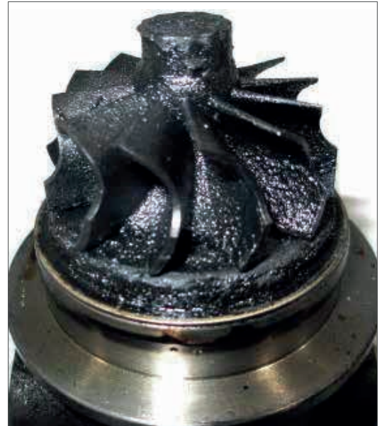
Fig. 22.4.2 – Óleo no rotor da turbina.
