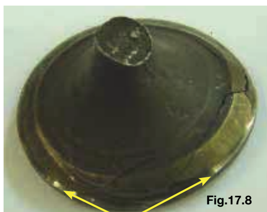
Cabeça da válvula quebrada na região do raio e haste
