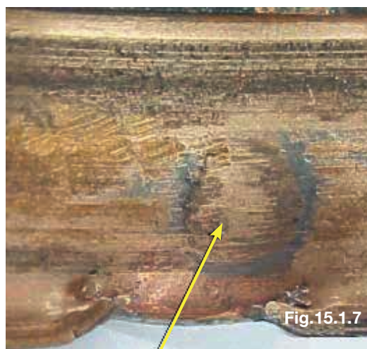
Marca interna provocada pelo corpo estranho
