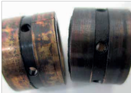
Fig. 22.1.1.1 – Lubrificação deficiente nos mancais radiais.
