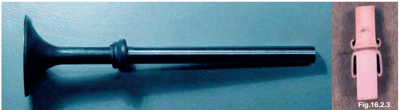
Região da solda na válvula bimetálica
