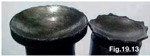
Detalhe de desgaste e quebra da base
