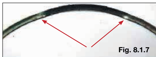
Anel montado torcido
