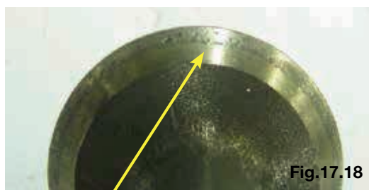
Desgaste na região da cabeça da válvula
