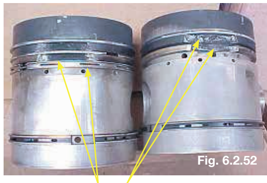
Paredes entre canaletas fraturadas em pistões aplicados em motores Ciclo Diesel
