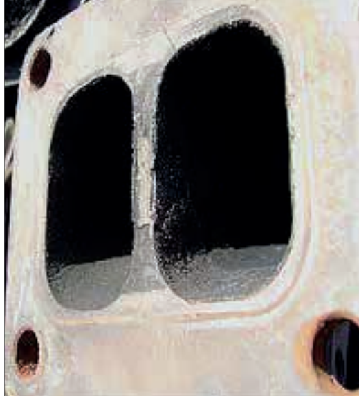
Fig. 22.3.2 – Trincas e escamação da carcaça.
