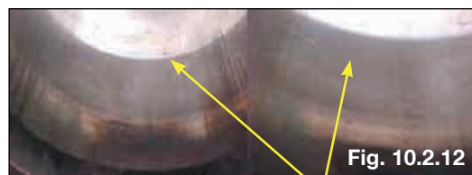
Fig. 10.2.12 Camisa "espelhada" devido à rotação constante
