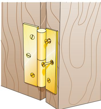
Unión mediante bisagra.
