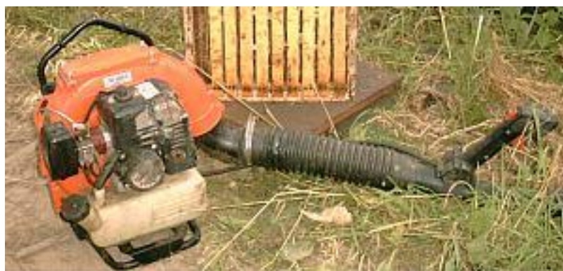
Figura 212. Equipamento para produção de um jato de ar ou soprador.
