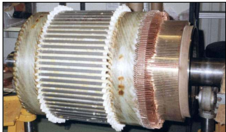
Estator y rotor de una máquina de corriente continua durante su proceso de fabricación.
