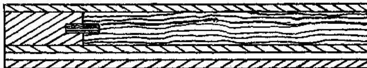
Fig. 158 — Compensado lamicerne, com laminado na frente.
