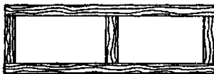
Fig. 150 — Quadro dos compensados das figuras 148 e 149.
