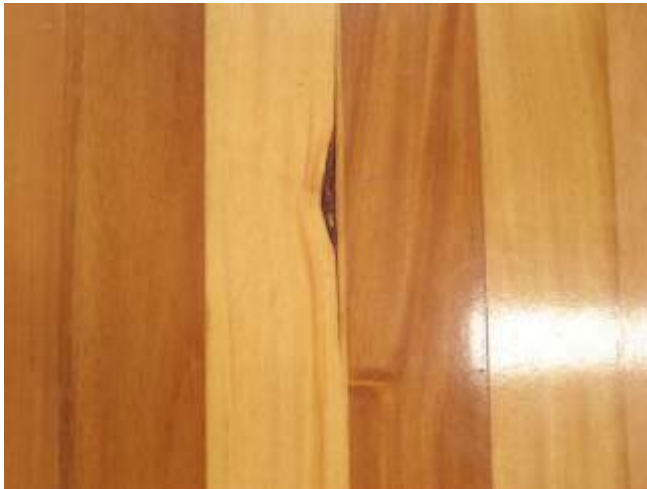
Figura 51. Canal de resina.
