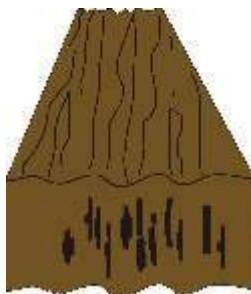
Figura 14. Peça de madeira com rachaduras internas.
