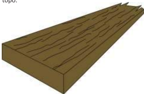
Figura 13. Peça de madeira com rachaduras superficiais
