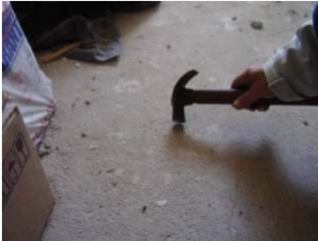
Figura 22. Teste de aderência utilizando martelo.
