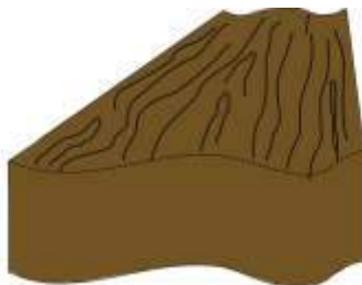
Figura 15. Peça de madeira apresentando colapso.
