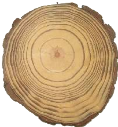
Figura 01. Plano transversal do tronco de conífera.
