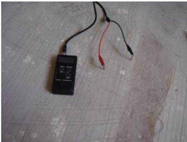
Figura 23. Medição de umidade do contrapiso.
