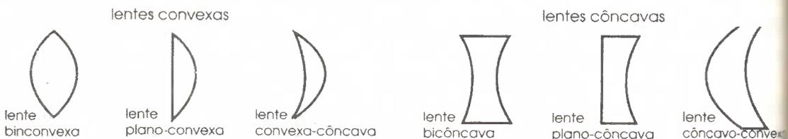
Um feixe de raios luminosos paralelos ao eixo principal que atravessam uma lente convexa, concentram-se depois de a atravessarem num ponto  $F$ , chamado *foco* da lente e que está situado no eixo principal.
