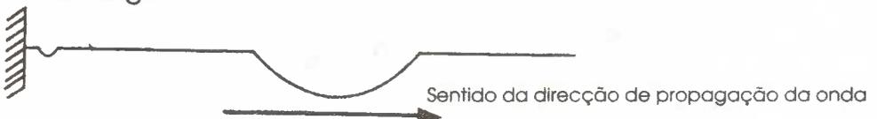
Este fenómeno chama-se reflexão e é uma propriedade da propagação das ondas mecânicas.
