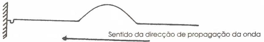
Depois a onda atinge o ponto fixo (extremidade esticada) e regressa ao ponto de origem.
