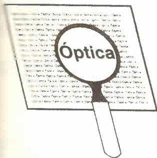
A lupa é uma lente biconvexa de pequena distância focal. Colocando um objecto, um livro, um postal ou, por exemplo, a escala dum aparelho de medição entre a lente e o plano focal — o plano focal é o plano que passa pelo foco, perpendicularmente ao eixo principal — a lupa dá uma imagem virtual, direita e maior do que o objecto.
