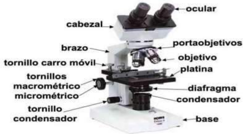
Figura 33. Componentes del microscopio óptico compuesto
