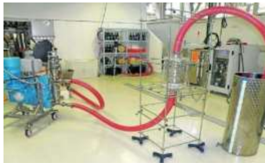
Figura 76. Equipo de pulsos eléctricos de alta intensidad
