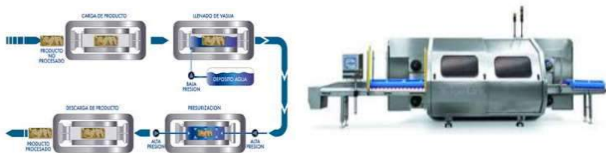
Figura 75. Esquema de funcionamiento de una unidad APH (arriba). Equipo de APH (abajo).
