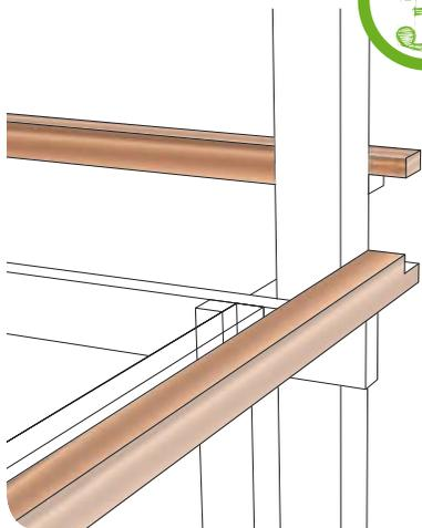
Se coloca an nivel y se termina de reforzar la unión con behuco o clavos para mejorar su resistencia
