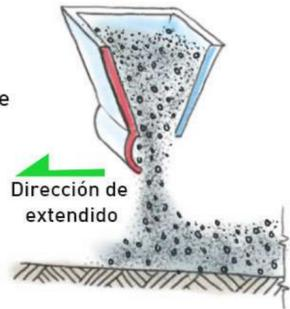
Se evita la segregación vertiendo a través de una tolva suficientemente alta
