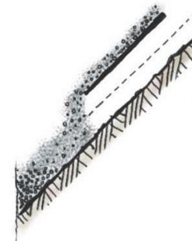
Figura 41. Métodos correctos e incorrectos de colocación del concreto
