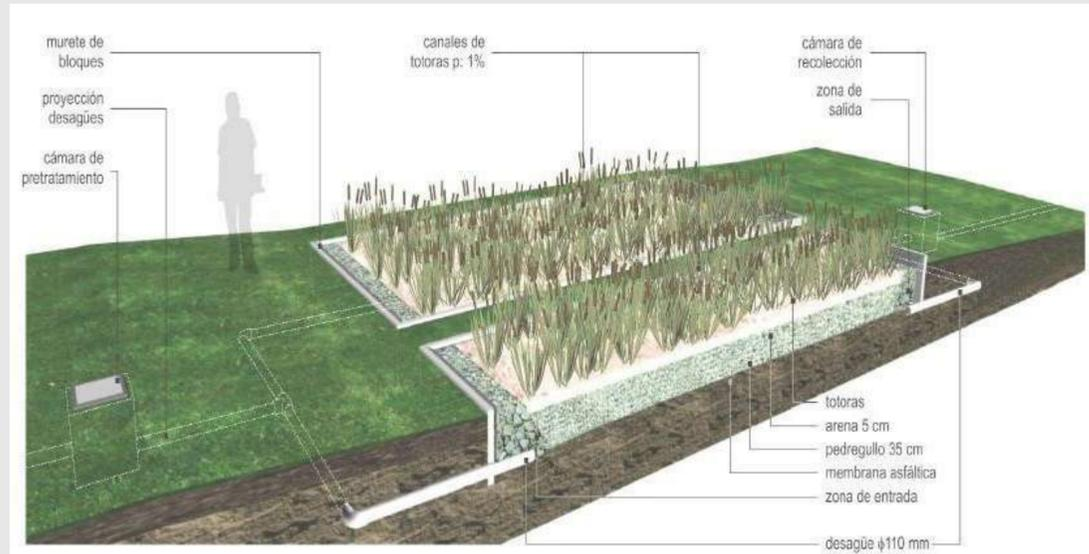
Figura 21. Esquema de un humedal construido de flujo subsuperficial. Fuente. Elaboración propia.
