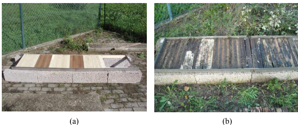
Figura 4 – Ensaio de campo “double layer”. a) No início (2006); (b) depois de 6 anos de exposição (2012).
