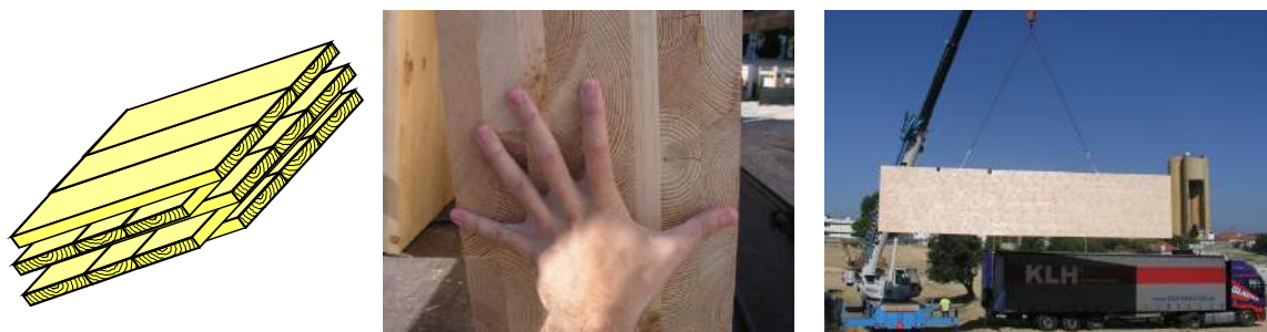
Figura 1 – Painel de madeira lamelada-colada cruzada.
