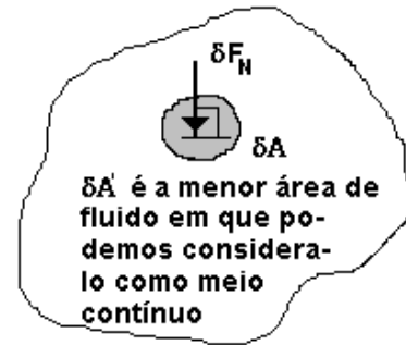
Figura 1.4-1 - Definição de Pressão
