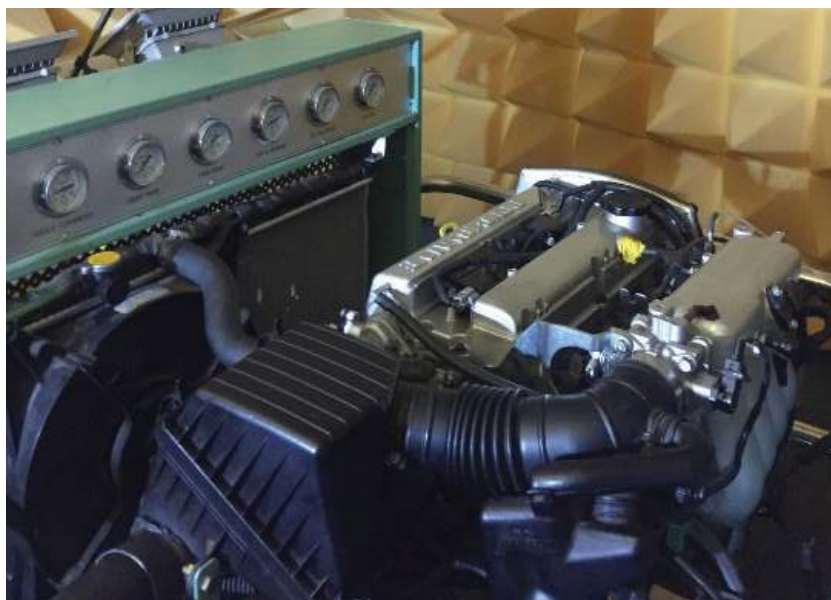
Figura 1 Motor DOHC 16V utilizado en la investigación
