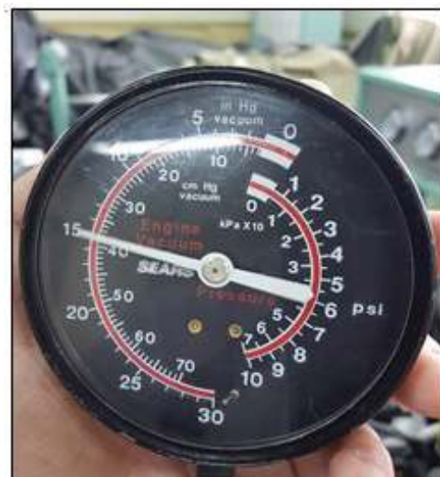
Figura 14 Variación de vacío por acción del solenoide de la válvula EGR controlado por un sistema difuso
