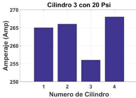
Figura 11 Motor con variación de compresión en el cilindro 3
