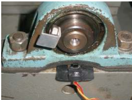
Figura 2 Montaje de emisor y receptor infrarrojo
