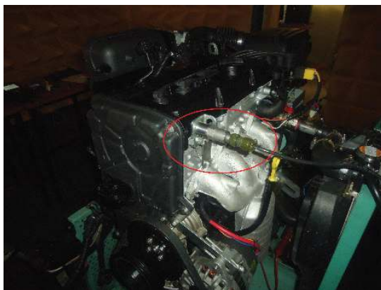
Figura 4 Posición del acelerómetro uniaxial
