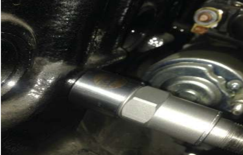
Figura 5 Ubicación del acelerómetro en la parte lateral del motor
