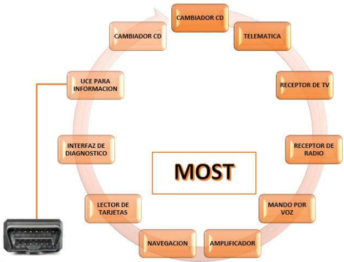
Figura 2 Topología: protocolo de comunicación MOST
