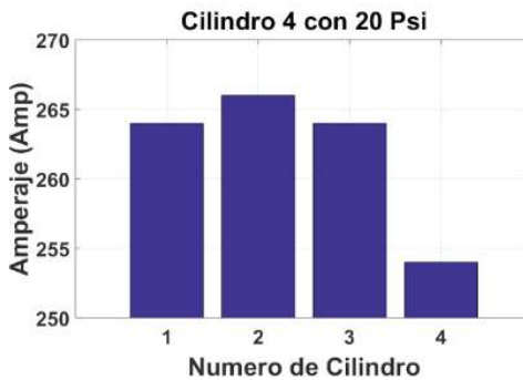
Figura 12 Motor con variación de compresión en el cilindro 4
