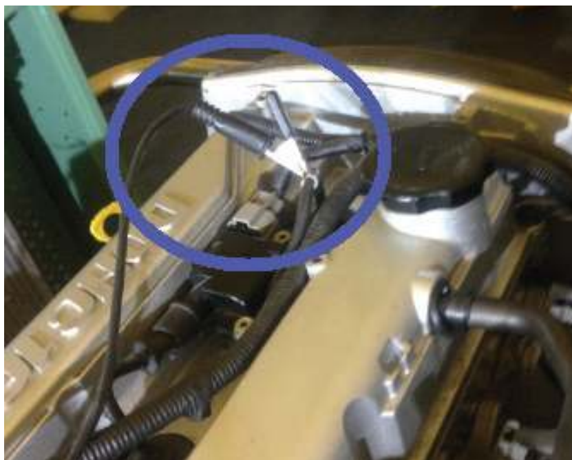
Figura 4 Pinza Inductiva conectada al cilindro 1
