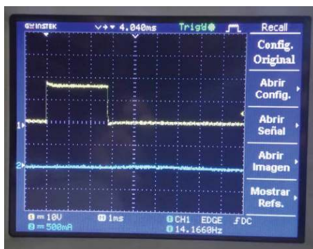
Figura 12 Tiempo de inyección del TPS en el osciloscopio
