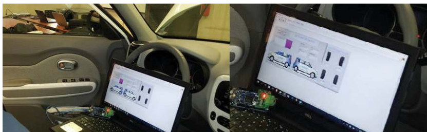
Figura 16 Prueba del monitor CAN en el vehículo Kia
