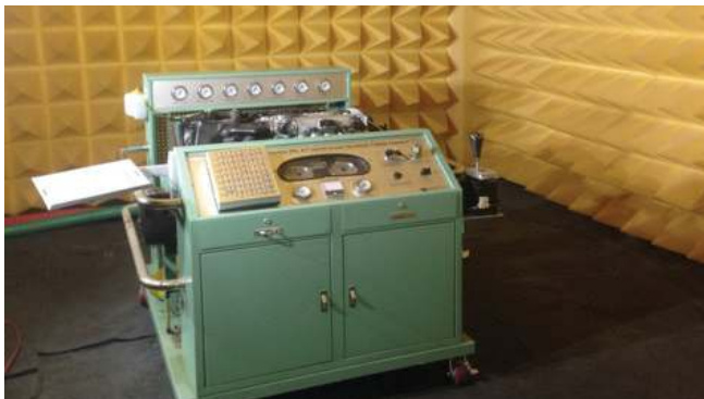
Figura 1 Cámara semi-anecoica y motor de pruebas
