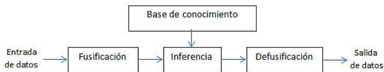
Figura 5 Esquema del sistema difuso
