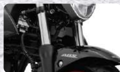
BARRAS TELESCÓPICAS FRONTALES DE 41 MM DE DIÁMETRO
