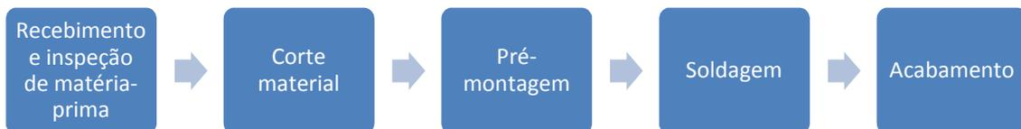
**Figura 4 - Fluxograma do processo de produção.**
