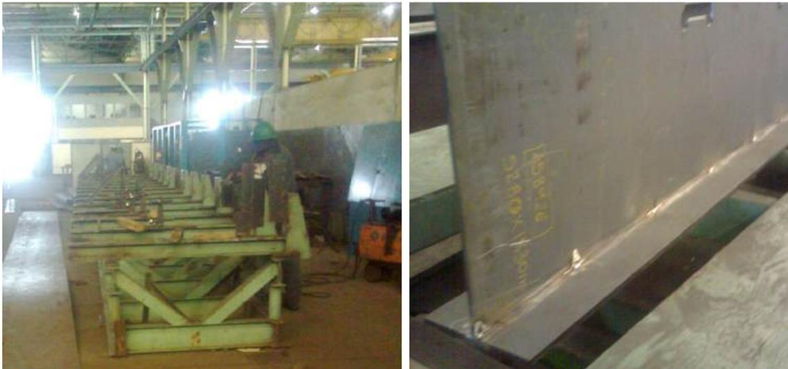
**Figura 6 – Gabarito de pré-montagem no local de soldagem com Eletrodo Revestido. Ausência de exaustor local para captação de fumos metálicos.**
