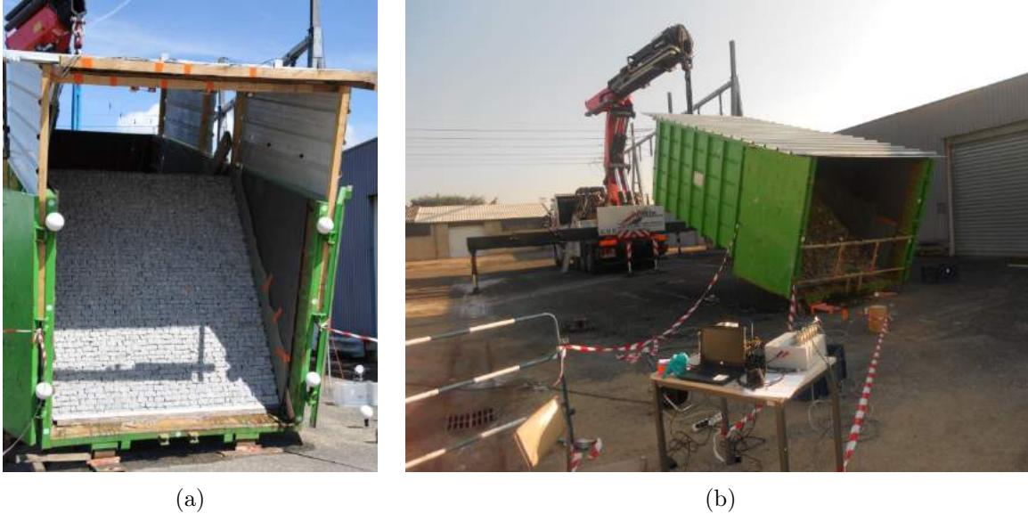
Figure 3.3 – Campagne expérimentale sur maquettes de barrages.
