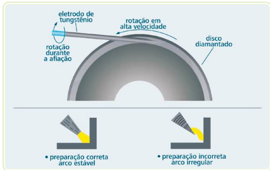
Figura 4.4: Importância de uma correta preparação da ponta do eletrodo
