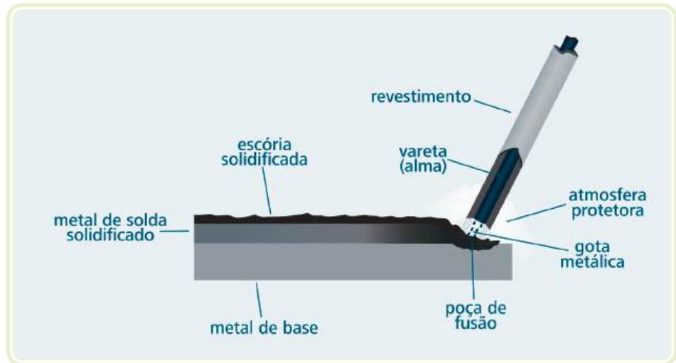
Figura 3.1: Soldagem eletrodo revestido mostrando seus principais elementos
