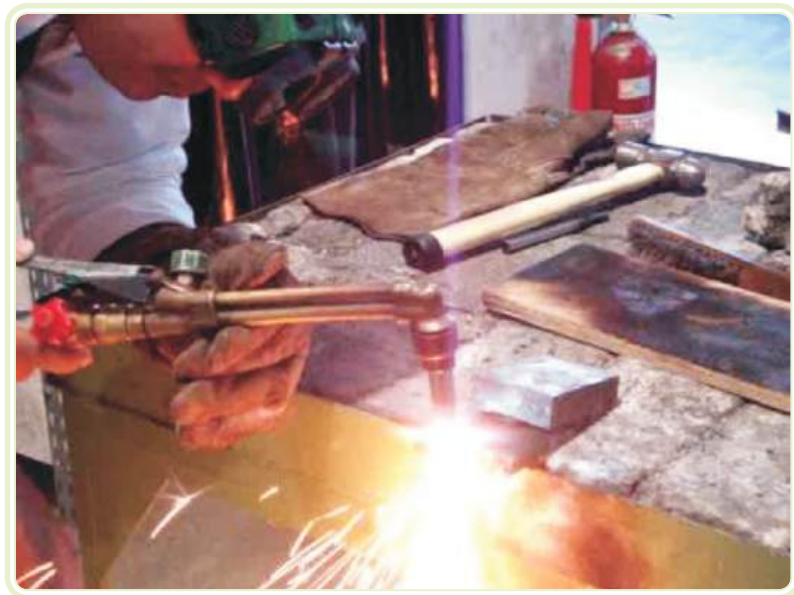
Figura 5.2: Corte oxiacetilênico (oxicorte)
