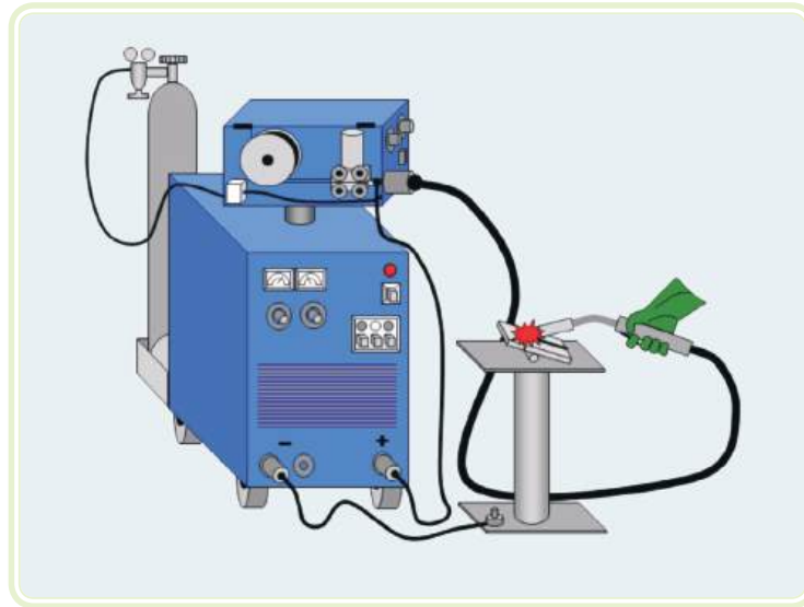
Figura 6.1: Esquema dos principais equipamentos de uma bancada de soldagem MIG/MAG
