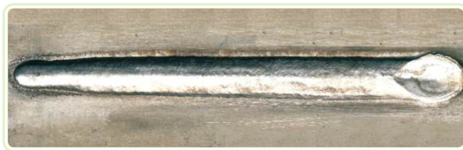
Figura 8.1: Cordão de solda aplicado na liga Al-Mg 5083
