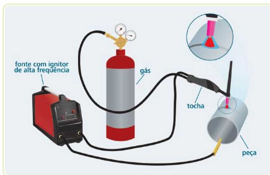
Figura 4.2: Esquema que apresenta os equipamentos presentes em uma soldagem TIG Fonte: CTISM, adaptado de Modenesi, 2003a
