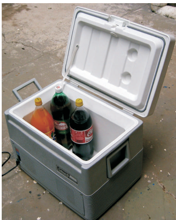
Figura A.8: Geladeira fabricada pela “Coleman”, que utiliza o efeito Peltier para resfriar o seu interior. Ela pode ser alimentada por uma bateria de 12V consumindo cerca de 4.5A (55W).
