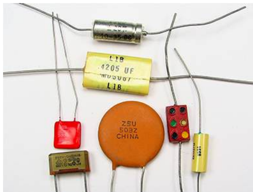
FIGURA 8.4 Estos son algunos de los condensadores típicos utilizados en los dispositivos electrónicos. El tamaño de un condensador no está necesariamente relacionado con su valor de capacitancia (créditos: Windell Oskay)
