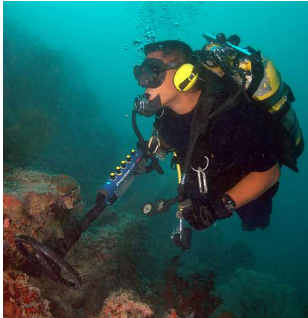
FIGURA 15.19 Cuando un detector de metales se acerca a un trozo de metal, la autoinducción de una de sus bobinas cambia. Esto provoca un cambio en la frecuencia de resonancia de un circuito que contiene la bobina. Ese desplazamiento es detectado por los circuitos y transmitido al buceador por medio de los auriculares (créditos: modificación del trabajo de Eric Lippmann, de la Marina de EE. UU.).
