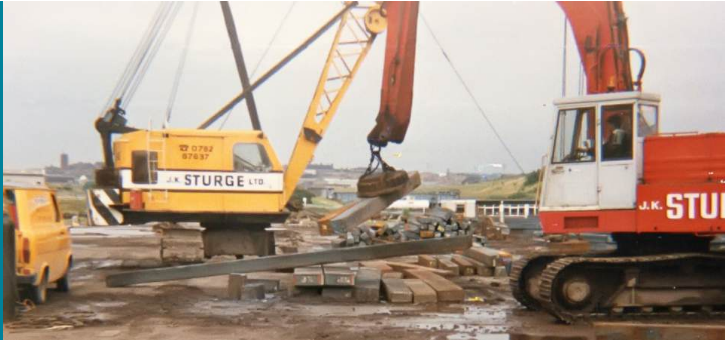
Figura 11.1 Un electroimán industrial es capaz de levantar miles de kilos de residuos metálicos (créditos: modificación del trabajo de “BedfordAI”/Flickr).
