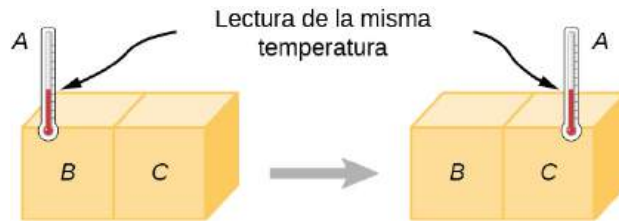
FIGURA 1.2 Si el termómetro A está en equilibrio térmico con el objeto B , y B está en equilibrio térmico con C , entonces A está en equilibrio térmico con C . Por lo tanto, la lectura en A permanece igual cuando A se mueve para hacer contacto con C .
