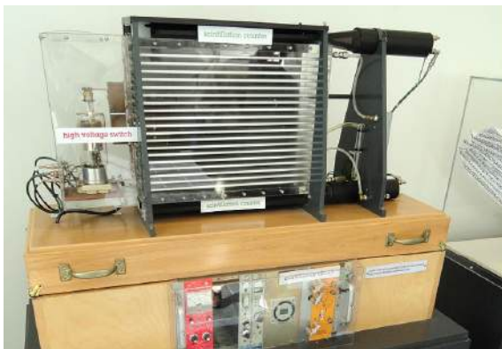
FIGURA 7.16 Se utiliza una cámara de chispas para trazar las trayectorias de las partículas de alta energía. La ionización que crean las partículas al pasar por el gas entre las placas permite que salte una chispa. Las chispas son perpendiculares a las placas, siguiendo las líneas de campo eléctrico entre ellas. La diferencia de potencial entre placas adyacentes no es lo suficientemente alta como para provocar chispas sin la ionización que producen las partículas de los experimentos con aceleradores (o los rayos cósmicos). Esta forma de detector es ahora arcaica y ya no se utiliza, excepto para fines de demostración. (crédito b: modificación de la obra de Jack Collins).
