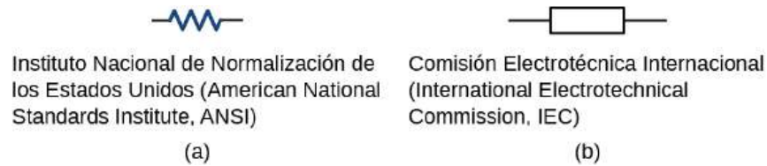
FIGURA 9.14 Los símbolos de un resistor utilizados en los diagramas de circuitos. (a) El símbolo ANSI; (b) el símbolo IEC.
