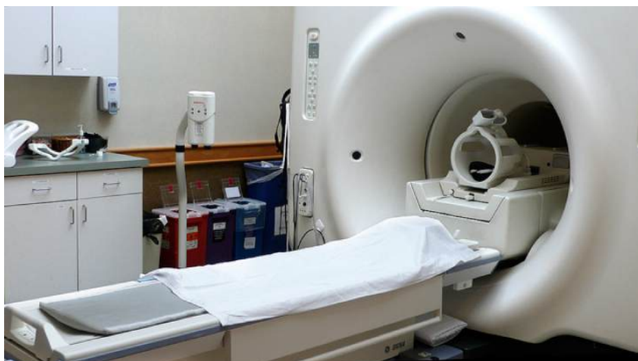
FIGURA 12.21 En una máquina de IRM el solenoide cilíndrico que rodea al paciente genera un gran campo magnético (créditos: Liz West)
