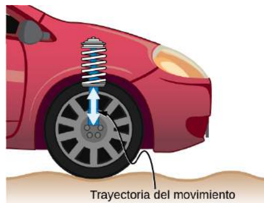
FIGURA 15.15 En un automóvil, el amortiguador amortigua el movimiento y disipa la energía. Esto es muy parecido a la resistencia en un circuito RLC . La masa y el resorte determinan la frecuencia de resonancia.
