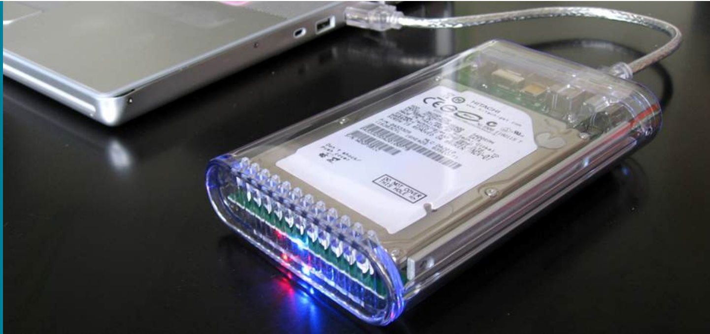
Figura 12.1 Un disco duro externo conectado a una computadora funciona codificando magnéticamente la información que se puede almacenar o recuperar rápidamente. Una idea clave en el desarrollo de dispositivos digitales es la capacidad de producir y utilizar campos magnéticos de esta manera (créditos: modificación de la obra de "Miss Karen"/Flickr).
