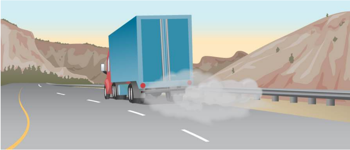
FIGURA 1.11 Los frenos humeantes de un camión que frena son una prueba visible del equivalente mecánico del calor.
