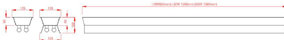
Figura 3: Luminária tipo calha, com corpo em chapa de aço pintada eletrostaticamente, com ou sem refletor facetado em alumínio de alta pureza e refletância.
