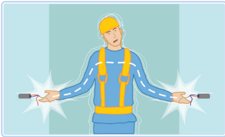
Figura 11.17: Queimadura por choque elétrico
