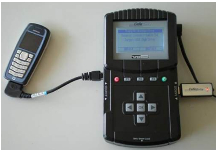
Figura 4. Extracción de información de un móvil a un dispositivo USB (de Cellebrite)
