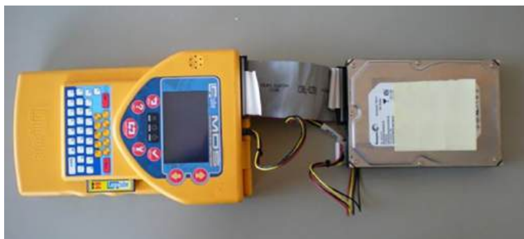
Figura 2. Duplicador o clonador de discos duros (de Logicube)
