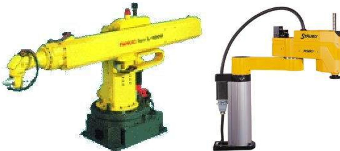
Fig. 2.19 – Braço do tipo polar, feito pela Fanuc, à esquerda, e um robô SCARA, produzido pela Stäubli, à direita.
