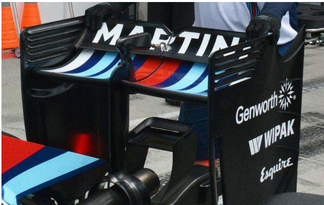
Figura 5.6: Alerón trasero del equipo Williams F1 Team empleado en el GP de Austria en 2016 con un mayor ángulo de ataque para compensar la reducción de la carga aerodinámica dada la menor densidad debida a la altitud del trazado. Fuente: Motorsport.com
