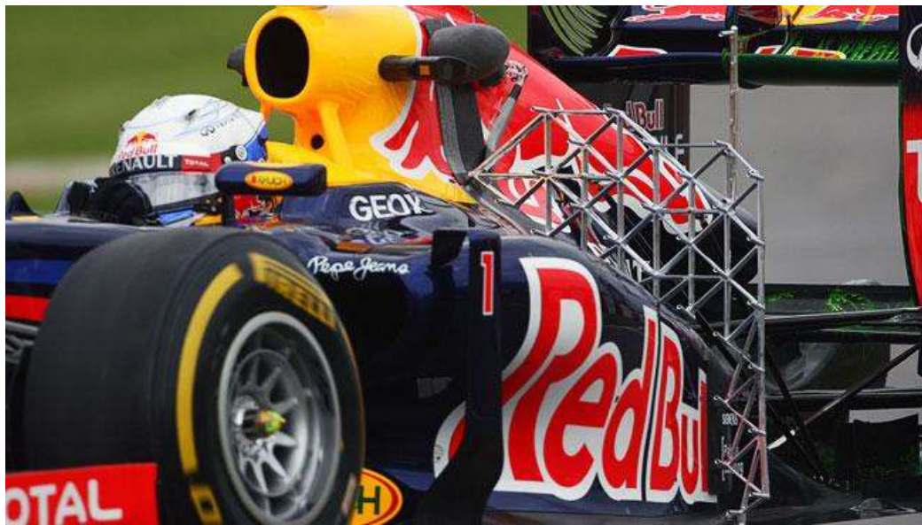
Figura 7.22: Parrilla de sensores pitot para medir la velocidad y presión del flujo aerodinámico en un cierto punto. Fuente: Omnicorse.it
