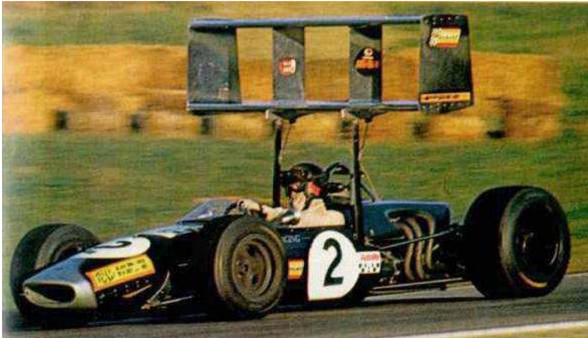
Figura 5.4: Alerón biplano de prueba instalado en un Brabham de Formula 2. Fuente: Formula 1 en estado puro
