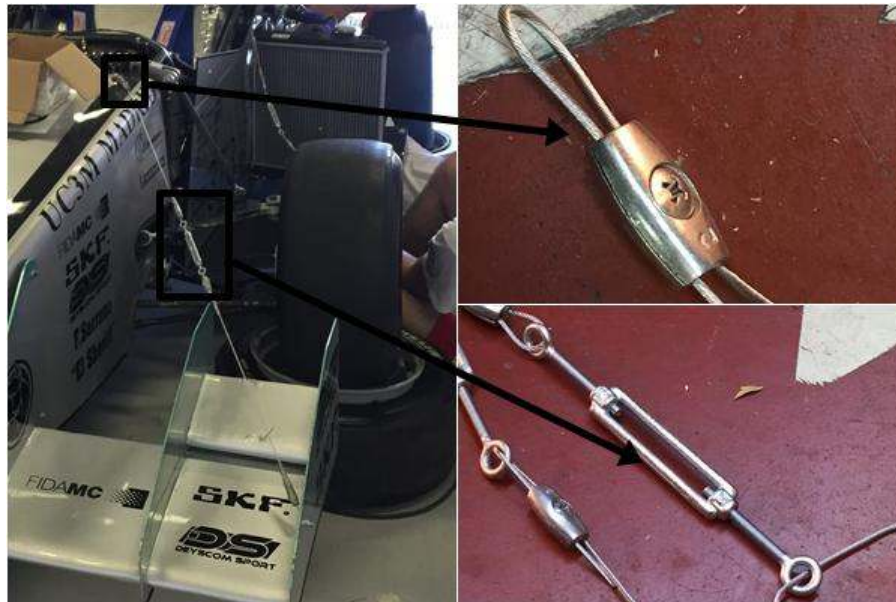
Figura 8.12: Detalle de los componentes de los cables del alerón delantero en la prueba de Formula Student Spain, con los prisioneros, los cables de acero trenzado de 2mm de diámetro y los tensores del cable. Fuente: Elaboración propia
