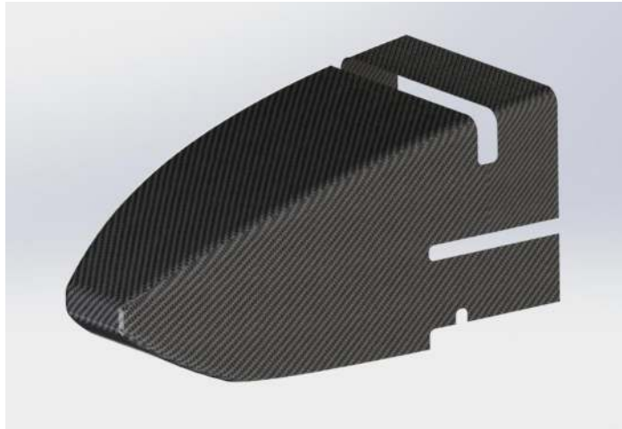
Figura 8.14: Modelo CAD del diseño final de las dos piezas que componen el morro del vehículo. Fuente: Elaboración propia
