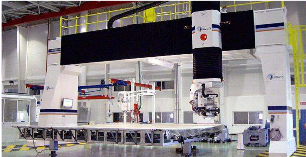
Figura 8.6: ATL tipo pórtico de la empresa MTorres utilizada para la laminación de las piezas planas.
