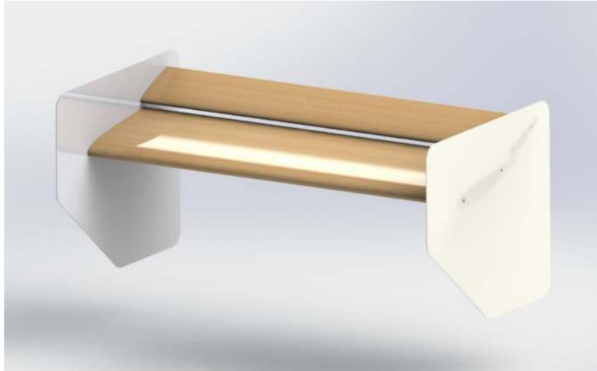
Figura 8.10: Modelo CAD del diseño final del alerón trasero montado en el vehículo.
