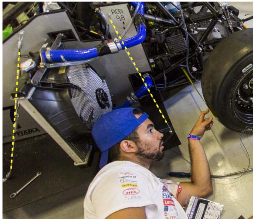
Figura 8.16: Tensores de cable de acero trenzado del lateral izquierdo del monoplaça. Fuente: Elaboración propia
