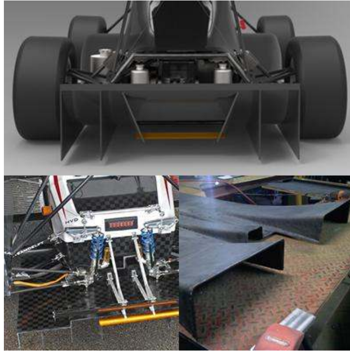
Figura 5.14: Diferentes soluciones adoptadas por los equipos de FSAE para los difusores. Fuente: Team Delft, UPV racing y Arus Team.
