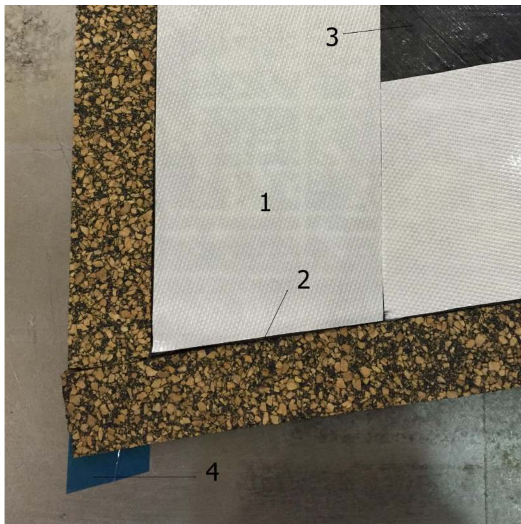
Figura 8.7: Diferentes componentes de la bolsa de vacío y de la pieza en el perímetro de la misma.
