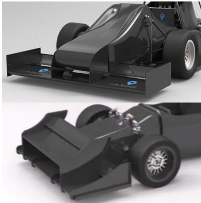
Figura 5.13: Diferentes soluciones adoptadas por los equipos de FSAE para los alerones delanteros. Arus 2015 imagen superior y UPV 2016 la inferior. Fuente: ARUS Team y UPV Racing
