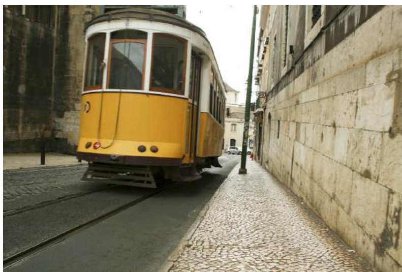
Figura 4.6.: A força que permite que o elétrico suba uma encosta ou trave na descida é a força de atrito estático entre as rodas e os carris.
