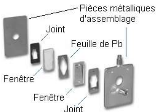
Figure 1.51. : Vue éclatée d'une cuve d'absorption IR pour solutions.
