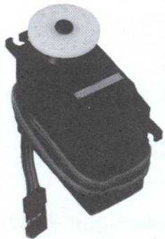
El cable de control recibirá pulsos de duración variable que será el tiempo en que el motor va a estar prendido y así cambiará la posición angular del eje, por lo que la duración del pulso estará relacionada con los grados de giro del eje. Esta forma de control es conocida por las siglas PCM, que significan modulación codificada del pulso.
