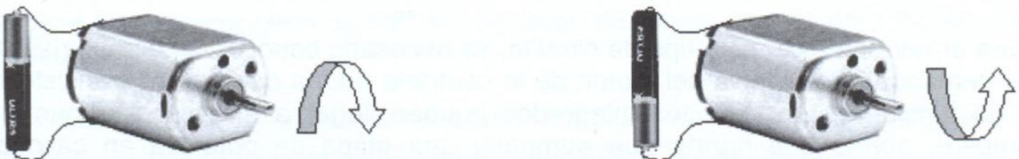
Una característica de este tipo de motores es que, por si solos, no cuentan con detectores de posición en su giro, por lo que una vez que se les aplica el voltaje giran a máxima velocidad hasta que se corta el voltaje.
