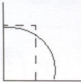
Permite el paso de señales desde una frecuencia 0 hasta la frecuencia de corte establecida
