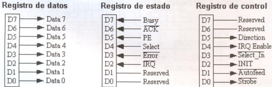
Estas señales de los registros de estado y control están codificadas para control de una impresora, cosa que en nuestro proyecto sustituiremos por las señales que se adapten al circuito del proyecto que se trabaje.
