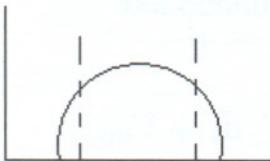
Permite el paso de señales dentro de un rango superior e inferior de frecuencias
