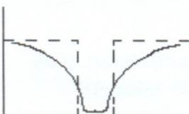
Permite el paso de señales en todo el espectro excepto en un rango establecido de frecuencias
