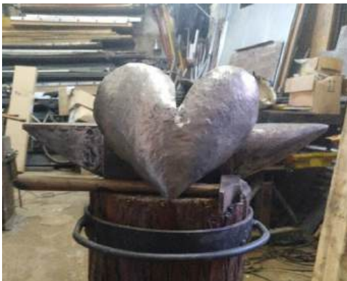
(Corazón de chapa realizado por Yaiza Garcia, repujado en frío a partir de chapa de 2mm, Foto tomada por la autora)
