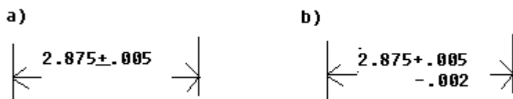
Figura No. 58.- Ejemplo para una tolerancia bilateral
