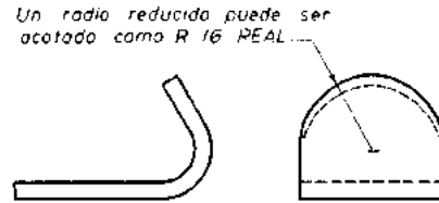
Acotación de un arco circular-R real
