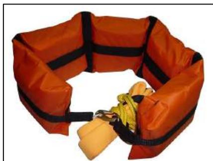
É confeccionado em espuma micro porosa, de PVC, com células fechadas, resistentes a intempéries. Tem dimensões de 930mm de comprimento, 140mm de largura e 80mm de espessura, e possui uma flutuabilidade de 160Kg positivos.
