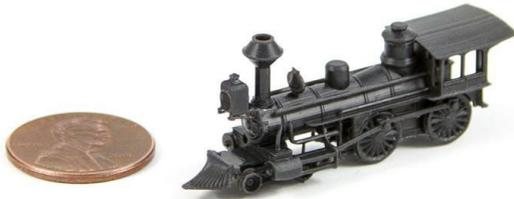
Figura 30 – Exemplo de peça produzida por DLP [64]
