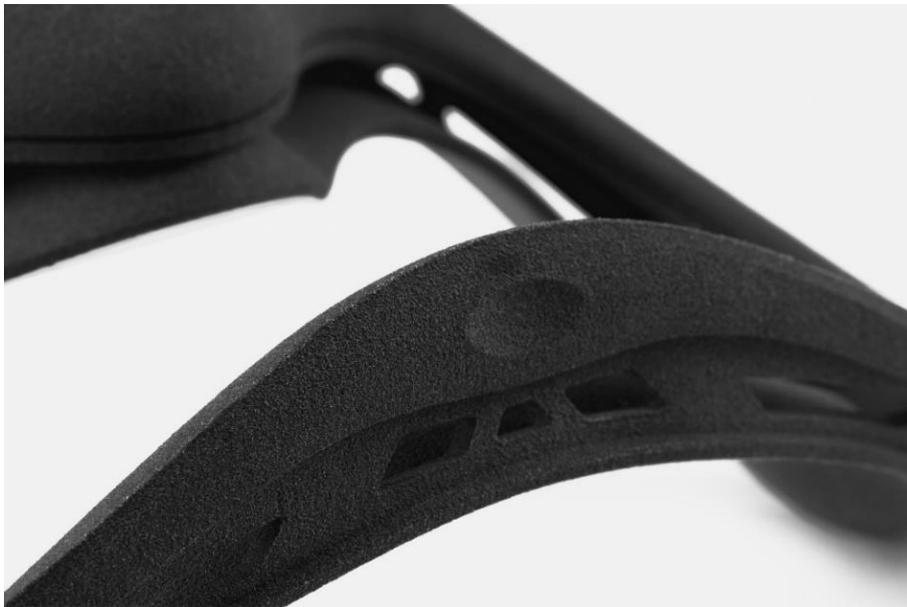
Figura 20 – Exemplo de peça fabricada por SLS [51].
