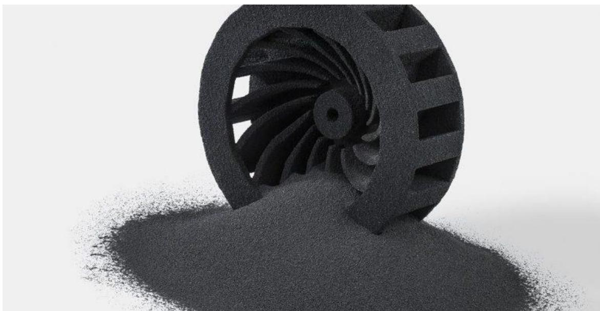
Figura 26 – Exemplo de peça fabricada por 3DP em carbono [59]
