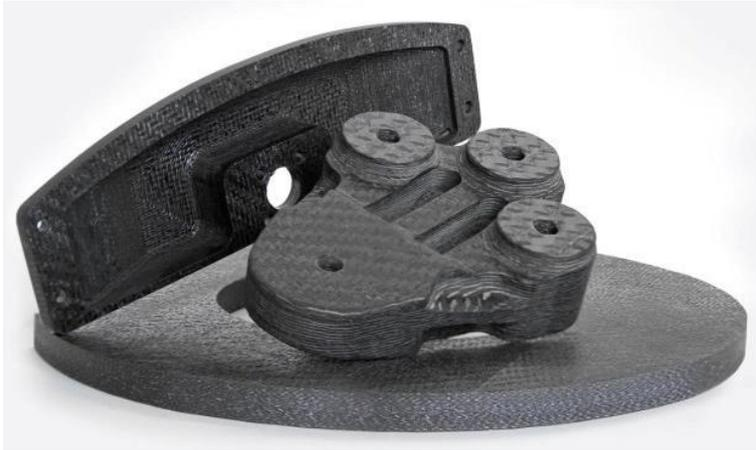
Figura 24 – Exemplo de peças em fibra de carbono produzidas por LOM [58]
