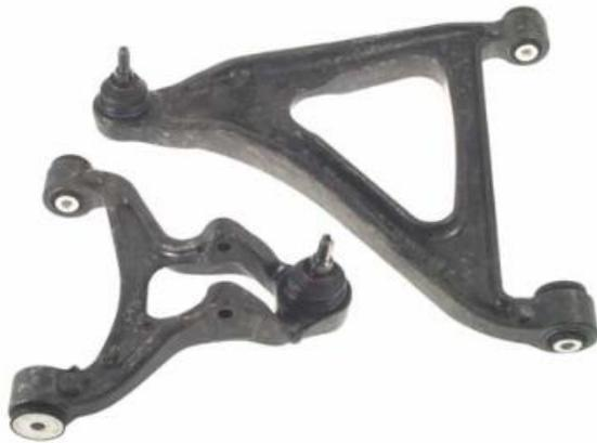
Figura 34 – Braços de suspensão do Lamborghini Sesto Elemento em Forged Composite® [24]
