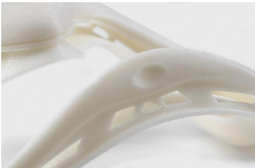
Figura 22 – Exemplo de peça produzida por FDM [51].
