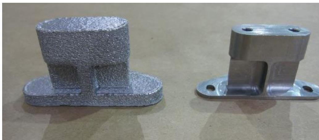
Figura 28 – Exemplos de peças em Ti64Al4V produzidas por EBM, antes e depois de maquinagem [62]
