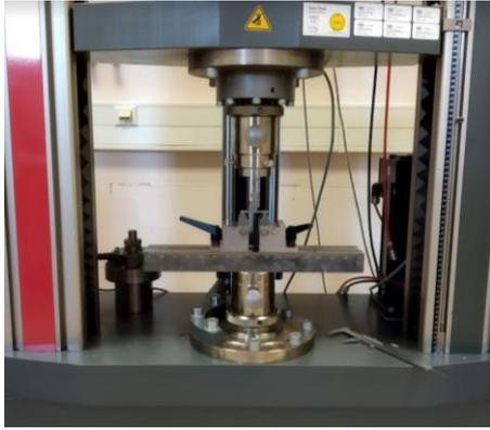
Figura 36 – Provette montado em Zwick Z100
